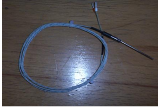
Şekil 3.6 K Tipi Mineral İzoleli Termo Eleman
