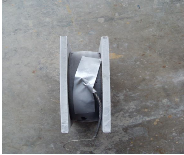
Şekil 3,8: Yalıtılmamış mesnedin yüzeyden irtibatlaşmış ısı çifti ile görünüşü
