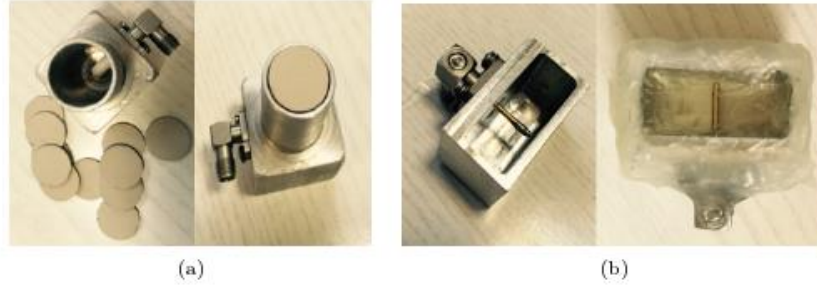
Şekil 41: HHMDG deneyinde kullanılan antenin hazırlık aşamaları (a) İkinci HHMDG kurulumunda kullanılan yüksek geçirgenli materyal ile doldurulma öncesi ve sonrası gönderme anteni (b) Yağ doldurulma öncesi ve sonrası dikdörtgen dalga kılavuzlu anten.
