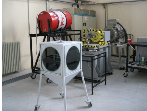
Resim 13: yakıt sprey test düzeneęi
