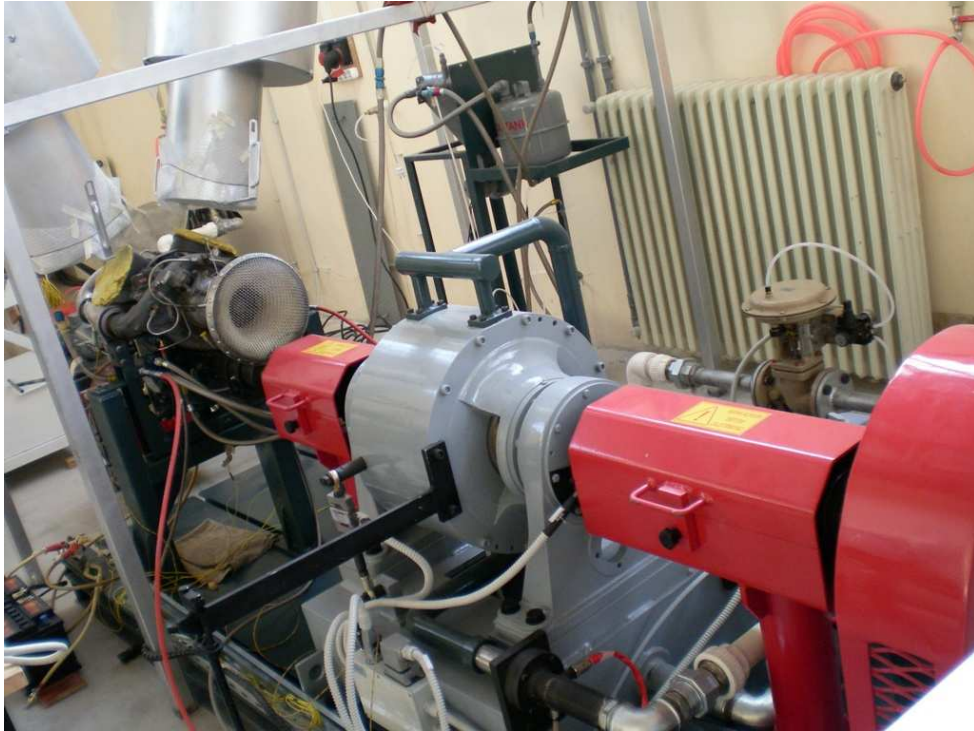
Resim 27: RollsRoyce Allison turboprop ve yük hücresi (su fren yükü-ön plan gri tambur)
