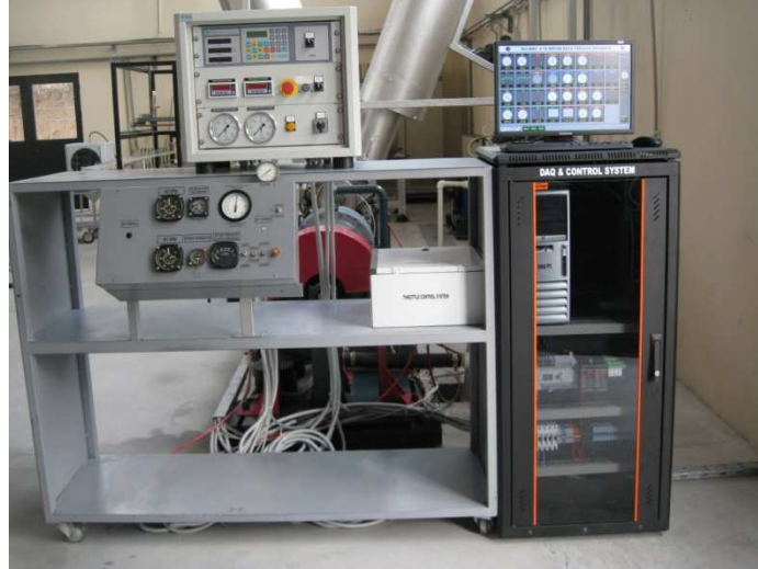
Resim 28: Su freni (yük hücresi) kontrol (üstte) ve motor kontrol (sağda)
