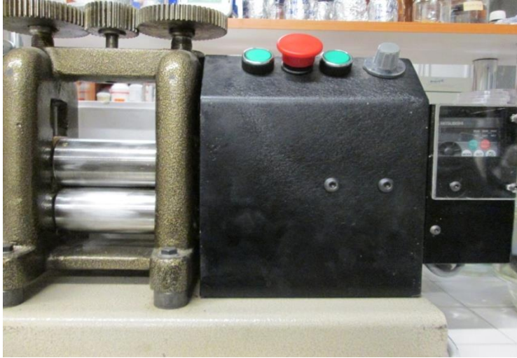
Şekil 2. Ekstrüderden elde edilen şeritleri film haline getirmek için kullanılan haddeleme makinesinin görüntüsü.
