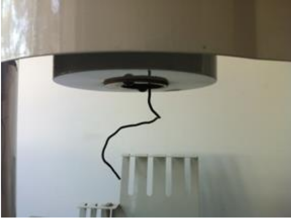
Şekil 5. Viskozite ölçümü sırasında kapiler reometriden çıkan hemiselüloz polimerinin görünümü.
