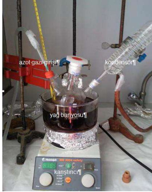
Şekil 3. PEG-PCL-PEG kopolimer sentez aşamasında kullanılan deney düzeneği
