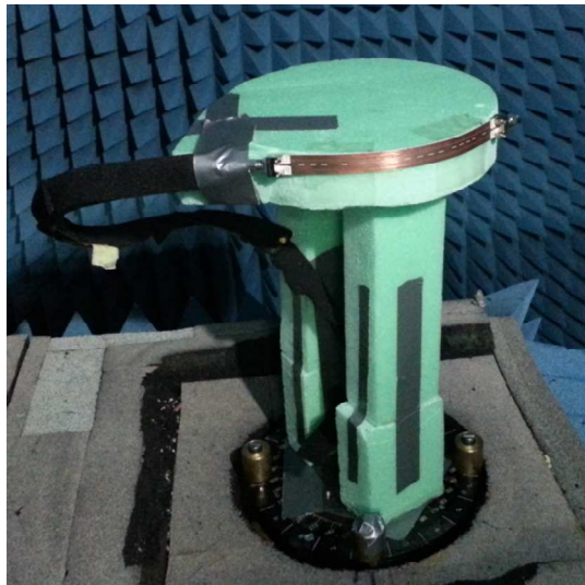
Şekil 19. 1 x 16 yarıklı SSTDK dizisinin ölçüm düzeneği ( R = 10 cm).
