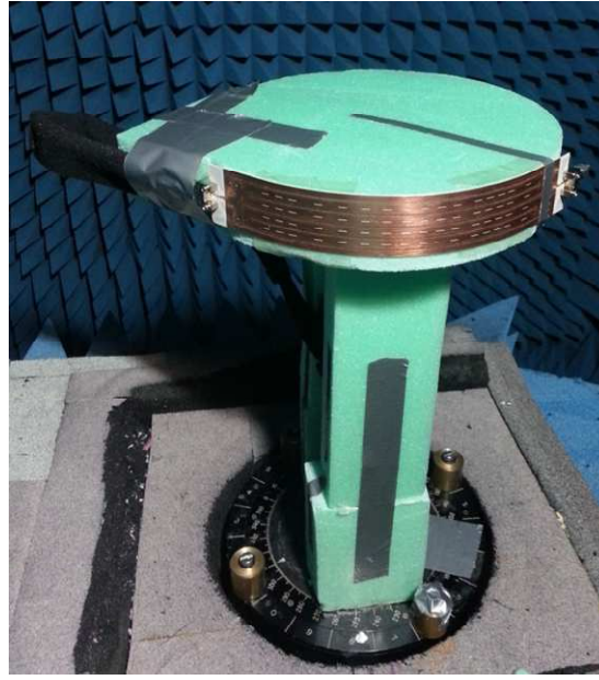
Şekil 39. 4 x 16 yarıkli STDK dizisinin ölçüm düzeneği ( R = 10 cm).
