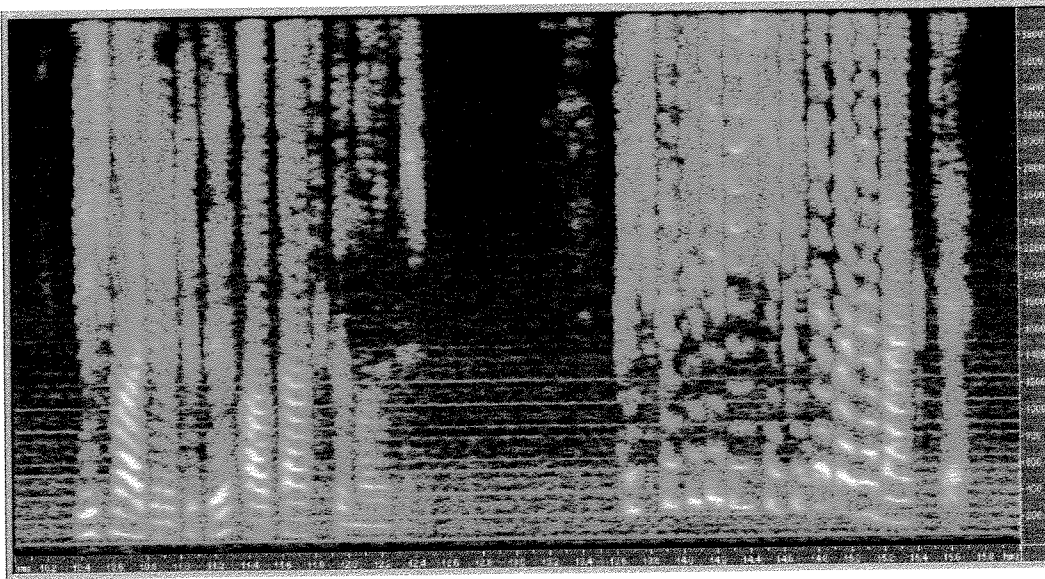
Çizim 13: Gürültülü konuşmanın (SGO = -5 dB) Ephraim-Malah Yöntemi ile önerilen yöntemin birlikte kullanılarak temizlenmiş hali.
