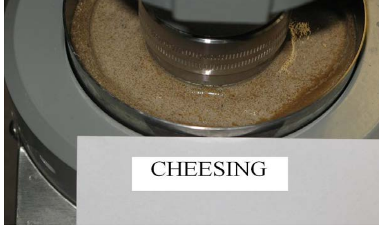
Şekil-29 Sondaj Çamuru Üzerinde Oluşan Peynirsi Tabaka (Cheesing)
