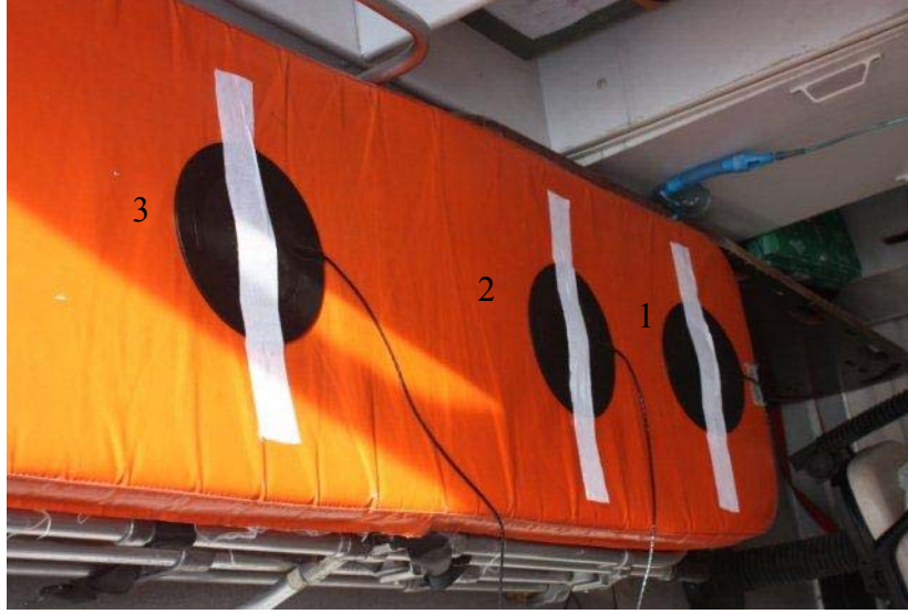
Şekil 4.5 Yatan kişi/sedyede ivme ölçerleri yerleştirme planı
