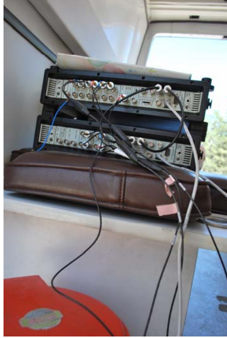
Şekil 3.1 Ölçümlerde kullanılan 12 kanallı analizör
