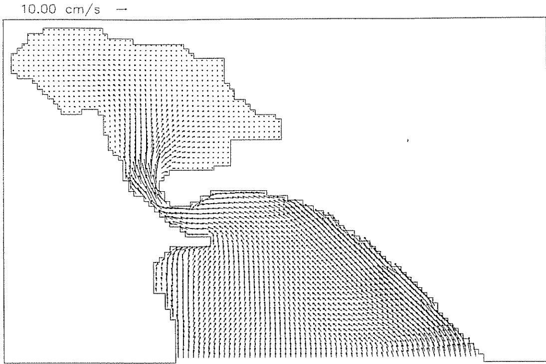
Çizim 5.4-a Gelgit etkisinin başlangıcından 3 ( t=T/4 ) saat sonra, su taneciklerinin ortalama hız vektörleri.
