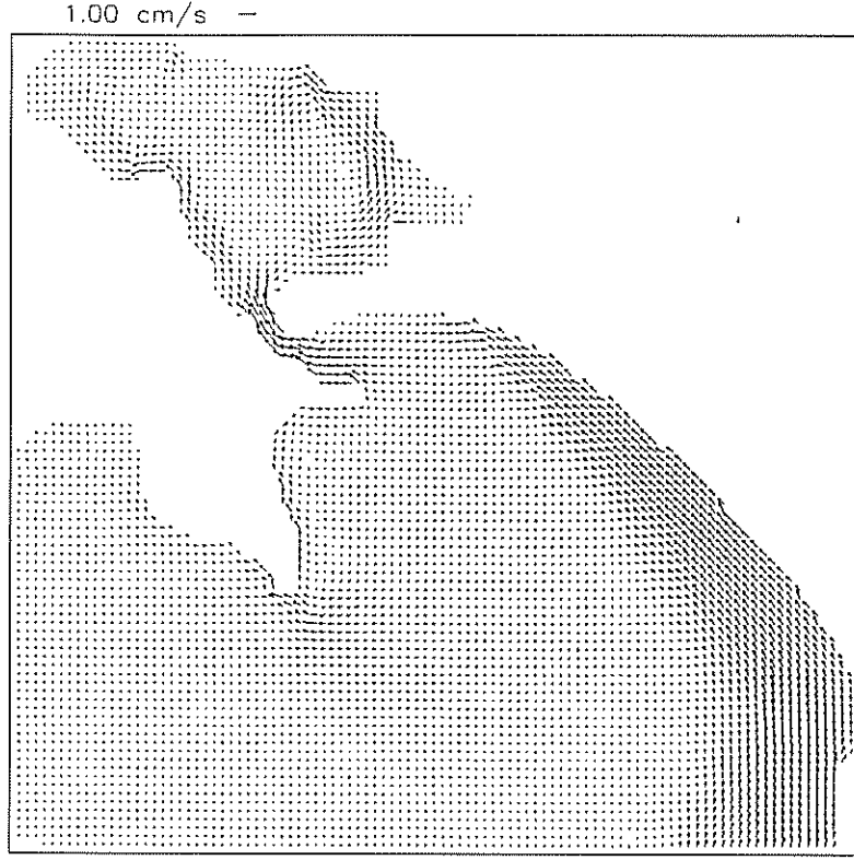
Çizim 5.5 Yoğunluk değişimleri nedeniyle oluşan ortalama akıntı düzeni
