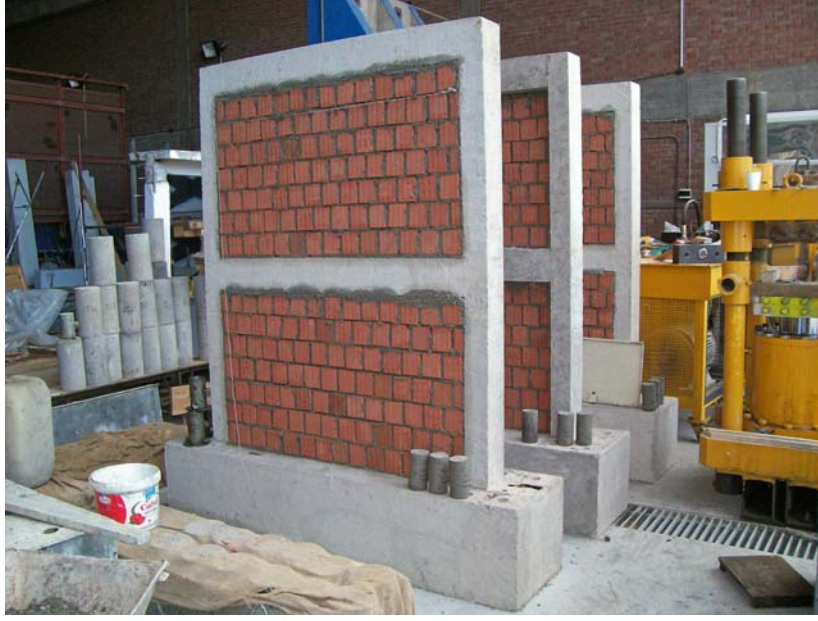
Şekil 52 Çerçeve Eleman Tuğla Duvar Örne İşlemi Görüntüsü
