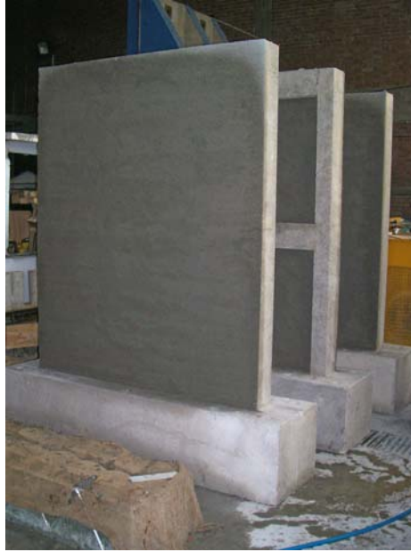
Şekil 53 Çerçeve Eleman Sıva Yapım İşlemi Görüntüsü
