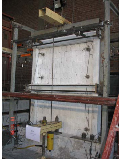
Şekil 157 TS6 (REFB) Elemanı Deney Öncesi Görünümü
