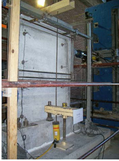
Şekil 151 TS3 (SF1ABM) Elemanı Deney Öncesi Görünümü
