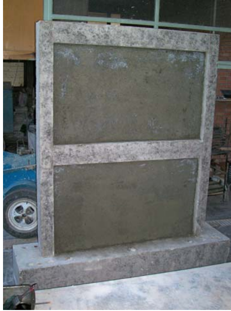
Şekil 55 Çerçeve Eleman Çelik Tel İçeren Harç Kullanılarak Güçlendirme İşlemi Görüntüsü
