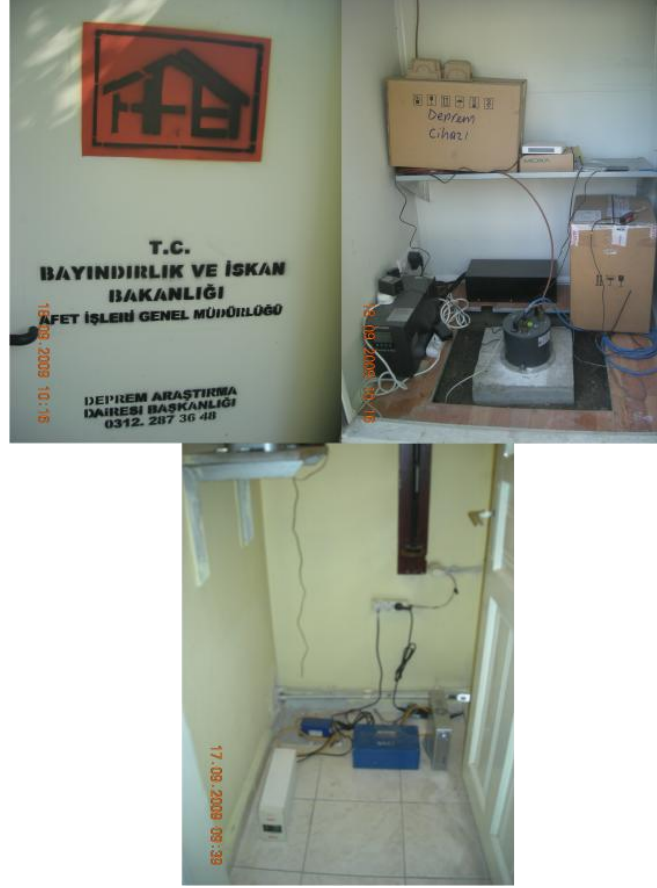
Şekil 15. Bolu ve Düzce sahalarında kurulu olan ivmeölçerler: BOL (üst sıra) ve DZC (alt sıra) kuvvetli yer hareketi istasyonları
