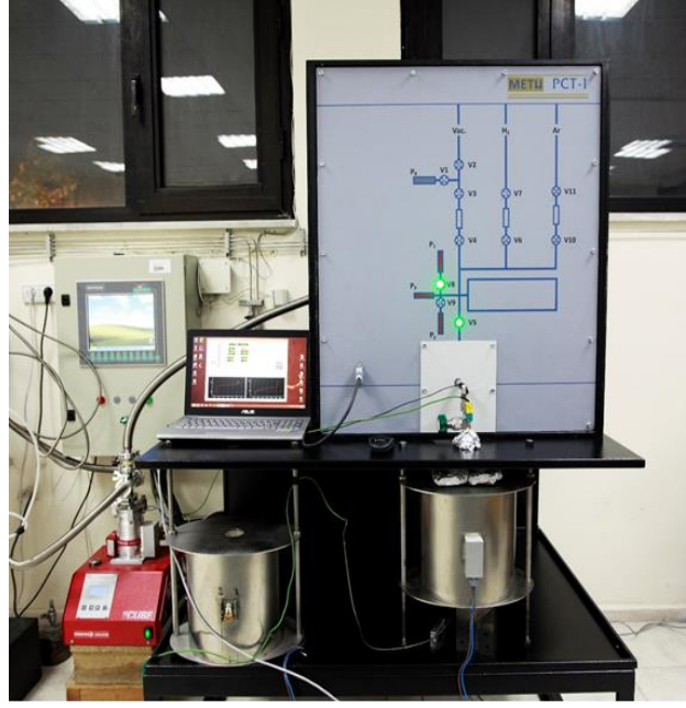
Şekil 2-3 Laboratuvarımızda geliştirilmiş PCT – Sievert ölçüm düzeneği. Cihazın kontrolü ve veri toplama bir bilgisayar aracılığı ile otomatik olarak yapılmaktadır
