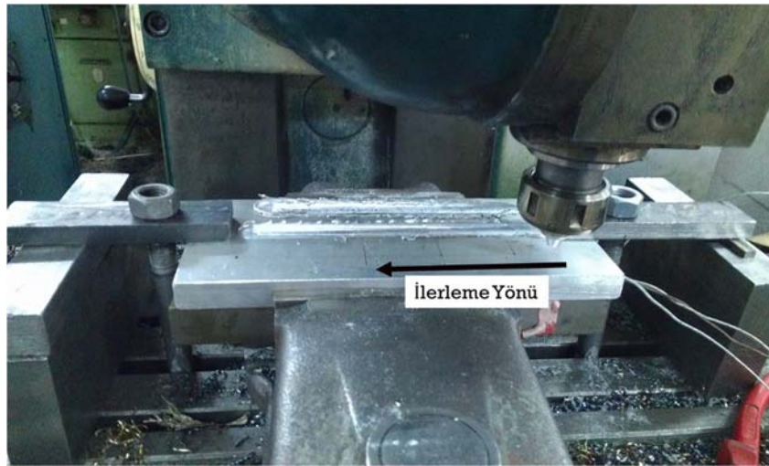
Şekil 35. SKP deneylerinde plakanın tezgâh üzerine yerleştirilmesi ve karıştırıcı ucun ilerleme yönü belirtilmiştir.
