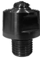
Şekil 53. Triflude uç ile denemelerde sıkça karşılaşılan kırılmaya ait görüntü
