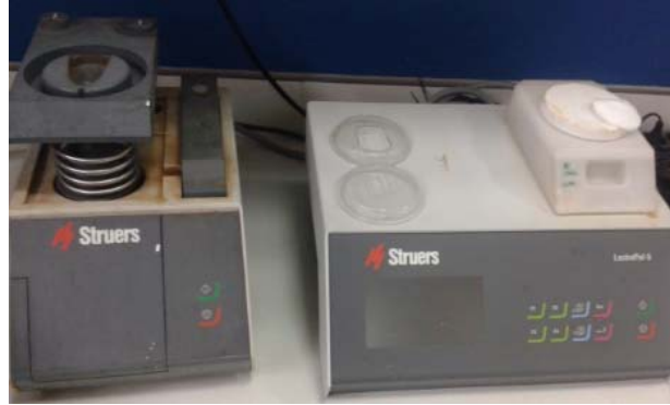
řekil 14. Elektrolitik parlatma/daęlama cihazı
