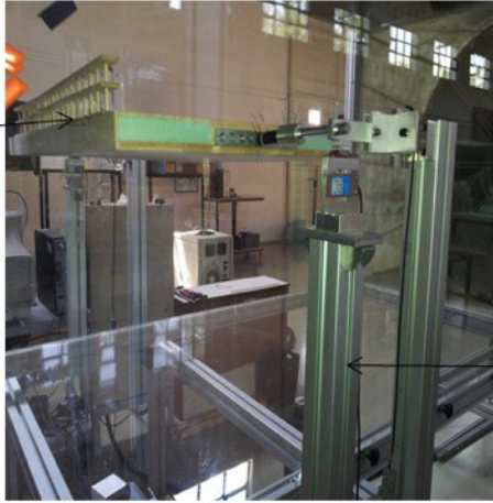
Şekil 3.8 Denge sistemi ve yük hücreleri
