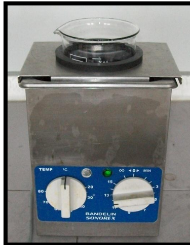
Şekil 11. Oksidatif Fonksiyonelleştirilen Karbon Nanotüplerin Aminosilanlama Öncesinde Ultrasonik Karıştırıcıda İşlem Görmesi
