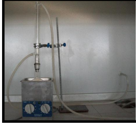
Şekil 9. Geri Akışlı Soğutucu (Reflux) Yöntemiyle İşlem Görmemiş Karbon Nanotüplerin Oksidatif Fonksiyonelleştirilmesi
