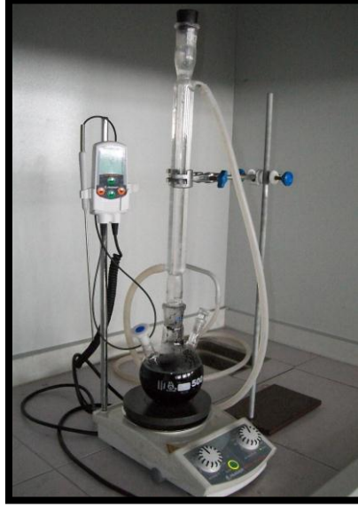
Şekil 12. Geri Akışlı Soğutucu (Reflux) Yöntemiyle Oksidatif Fonksiyonelleştirilen Karbon Nanotüplerin Aminosilanlama Reaksiyonu
