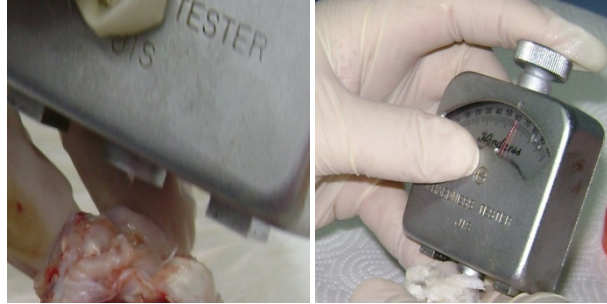
Şekil 7. Çıkarılan eklemlerin indentasyon cihazı ile sertlik ölçümlerinin yapılması
