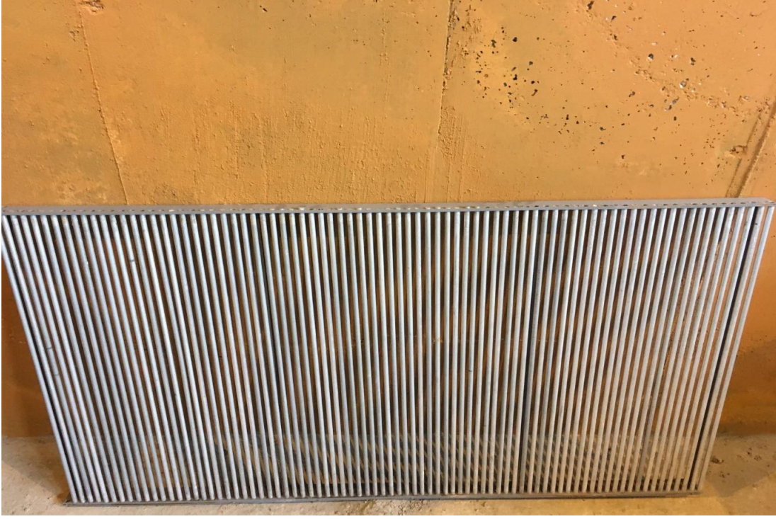
Şekil 3.21 e_2=6 mm açıklığa sahip ızgaranın görünüşü
