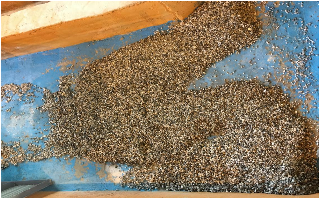
Şekil 3.14 Katı madde ile yapılan deneylerde (A2-Grubu) ana kanalın mansabında biriken katı maddenin üstten görünüşü ( e_1=3 mm, Z_1=10 cm, Z_2=25 cm, \alpha=20^\circ )
