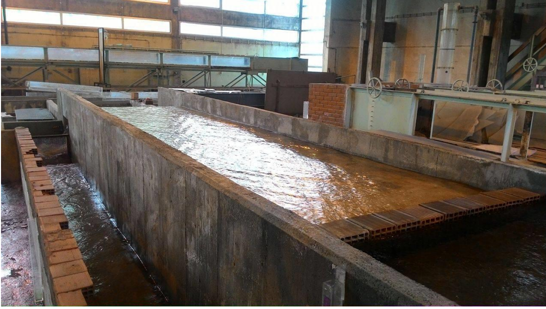
Şekil 2.3 Tirol tipi savağın memba kısmından görünümü
