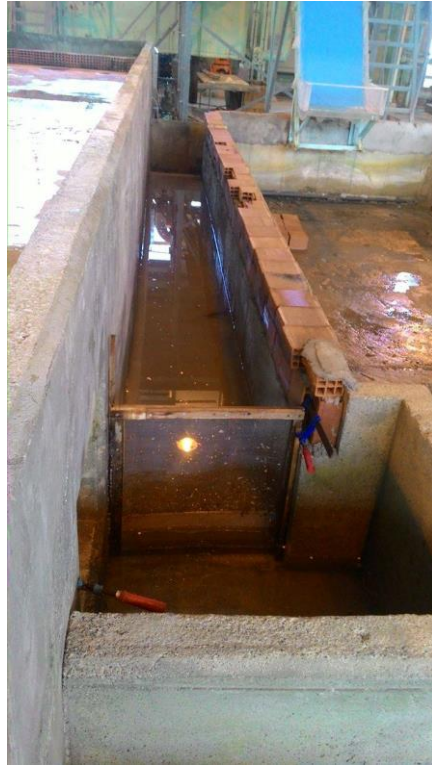
Şekil 2.7 Katı madde yakalama rezervuarı ve su alma kanalı
