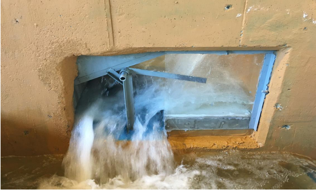
Şekil 3.11 Su ile yapılan deneylerde (A1-Grubu) ızgara üzerinde ve "toplama kanalı-2" nin mansabında ve "toplama kanalı-1" in kapalı olan memba kısmında akımın görünüşü ( e_3=10 mm, Z_1=5 cm, Z_2=20 cm, \alpha=10^\circ )
