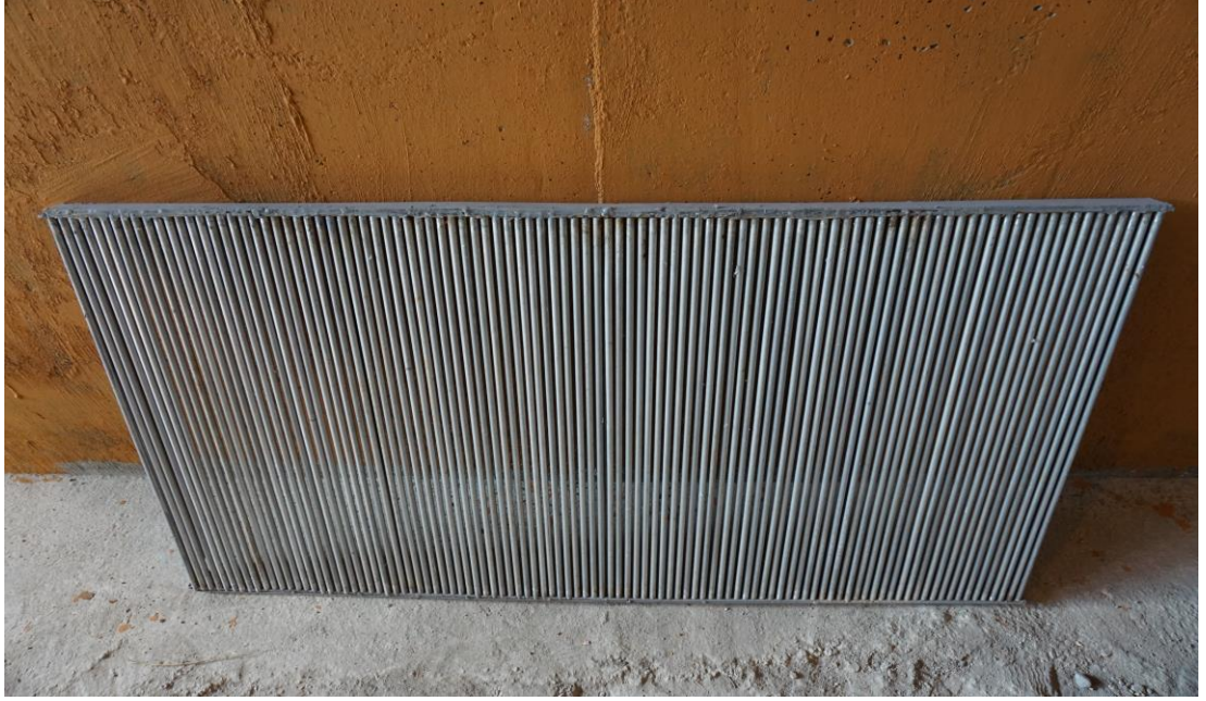
Şekil 3.20 e_1=3 mm açıklığa sahip ızgaranın görünüşü
