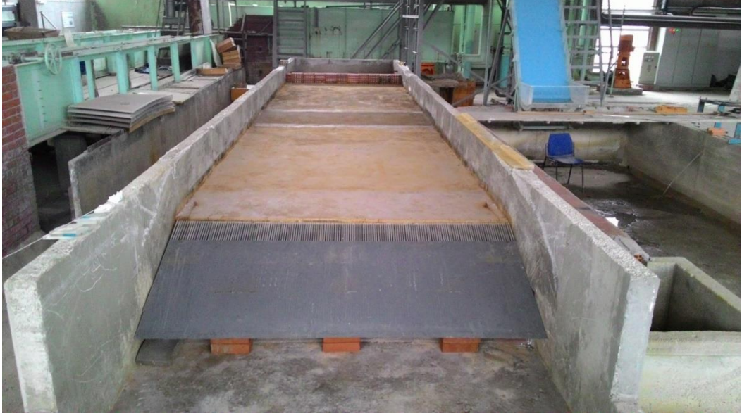
Şekil 2.5 Iızgara uzunluğunu ayarlama için kullanılan metal plakanın mansaptan görünümü
