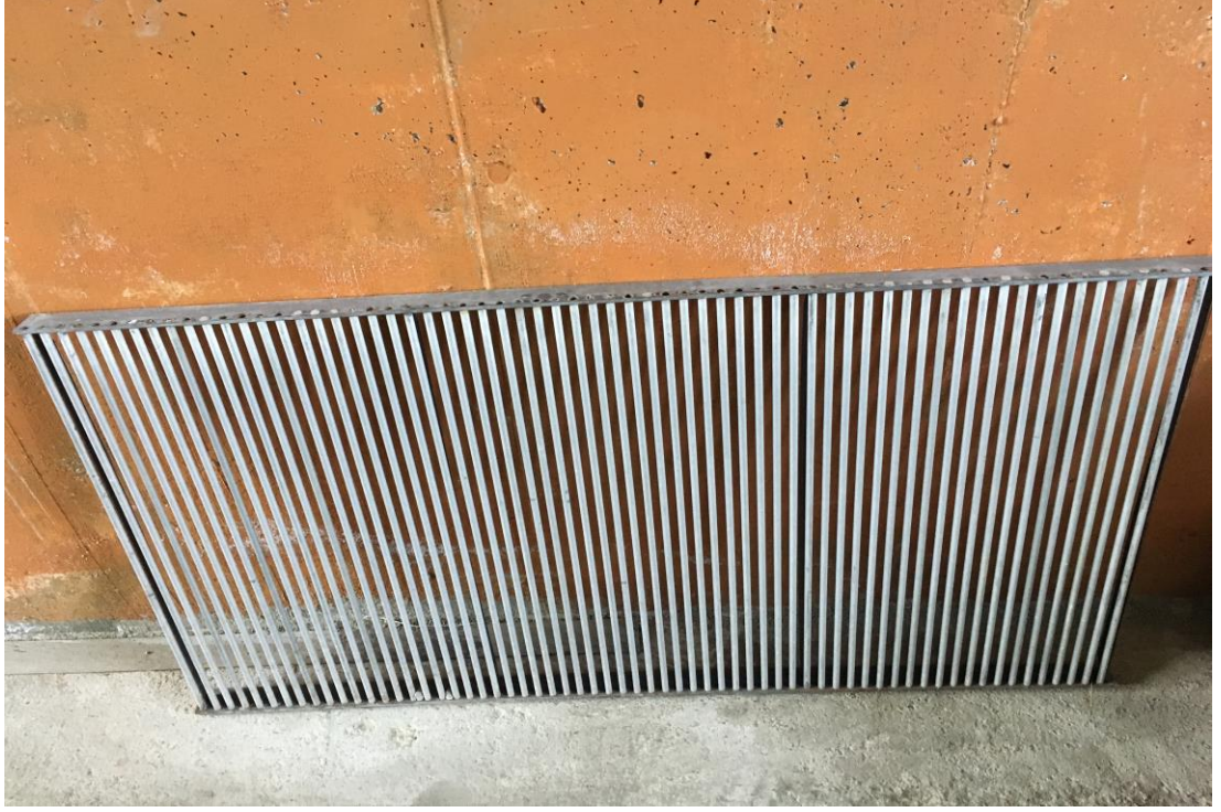
Şekil 3.23 e_4=15 mm açıklığa sahip ızgaranın görünüşü
