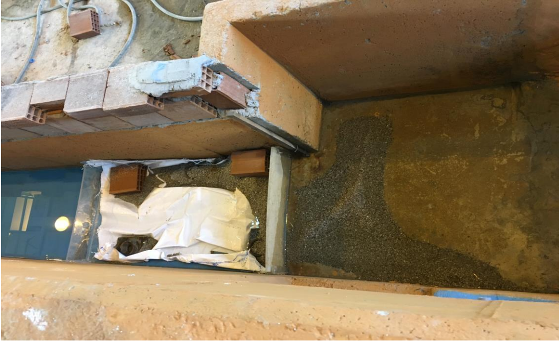
Şekil 3.12 Katı madde ile yapılan deneylerde (A2-Grubu) "toplama kanalı-2" nin memba kısmında çökeltme havuzu içerisinde toplanan katı maddenin üstten görünümü ( e_1=3 mm, Z_1=10 cm, Z_2=25 cm, \alpha=20^\circ )
