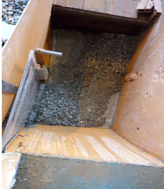
Şekil 3.18 Katı madde ile yapılan deneylerde (D-Grubu) "su alma kanalı" nın memba kısmında ve "toplama kanalı-1" in mansabında sürgülü kapaktan sonra toplanan katı maddenin üstten görünüşü ( e_4=15 mm, Z_1=10 cm, Z_2=20 cm, \alpha=30^\circ )
