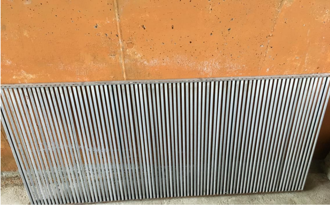
Şekil 3.22 e_3=10 mm açıklığa sahip ızgaranın görünüşü
