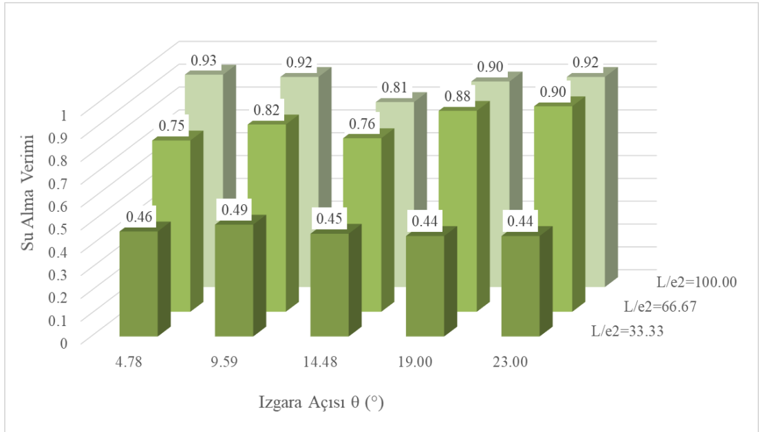
Şekil 2.27 Su alma veriminin ızgara açısı ve ızgara uzunluğuyla değişimi ( e_2=6 mm)
