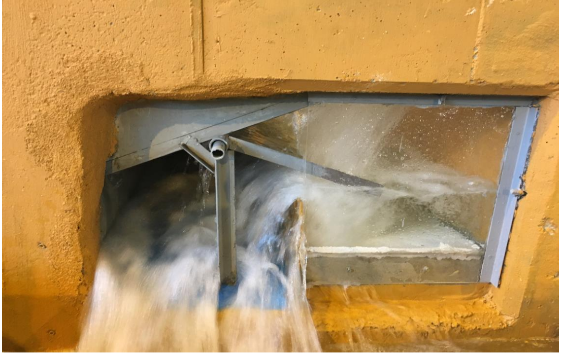
Şekil 3.9 Su ile yapılan deneylerde (A1-Grubu) ızgara üzerinde ve "toplama kanalı-2" nin mansabında ve "toplama kanalı-1" in kapalı olan memba kısmında akımın görünüşü ( e_1=3 mm, Z_1=5 cm, Z_2=20 cm, \alpha=20^\circ )
