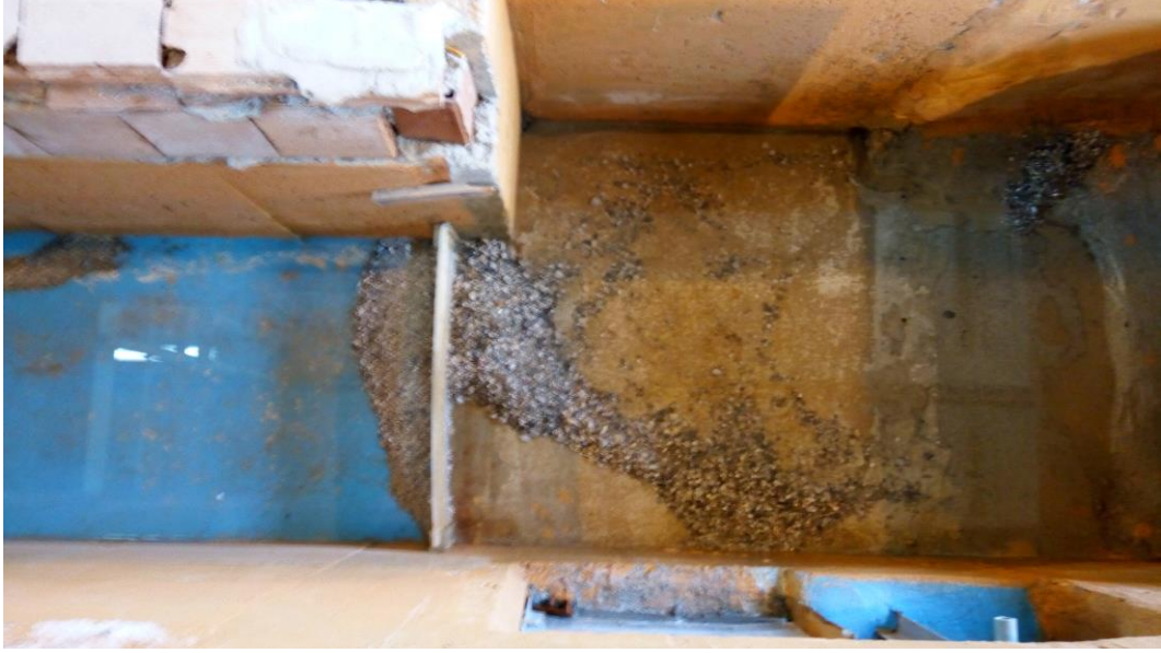
Şekil 3.17 Katı madde ile yapılan deneylerde (D-Grubu) "toplama kanalı-1" in mansabında sürgülü kapaktan sonra katı madde birikmesinin üstten görünüşü ( e_4=15 mm, Z_1=10 cm, Z_2=20 cm, \alpha=30^\circ )
