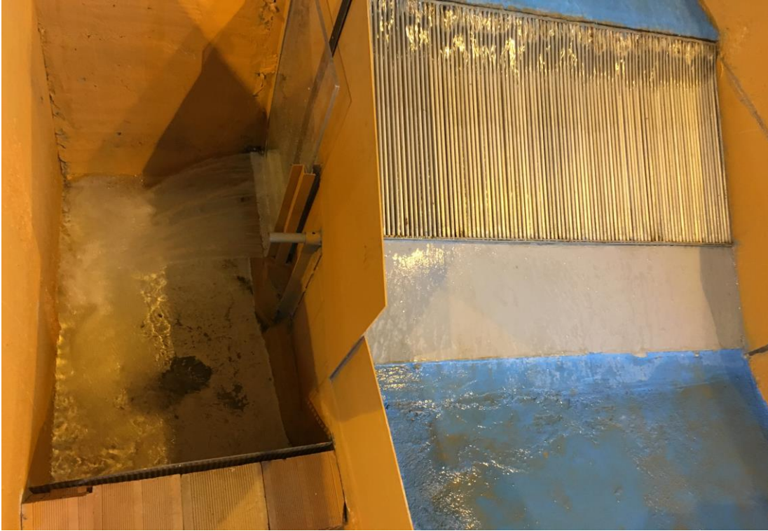
Şekil 3.8 Su ile yapılan deneylerde (A1-Grubu) ızgara üzerinde ve “toplama kanalı-1” in mansabında akımın görünüşü ( e_1=3 mm, Z_1=5 cm, Z_2=20 cm, \alpha=20^\circ )
