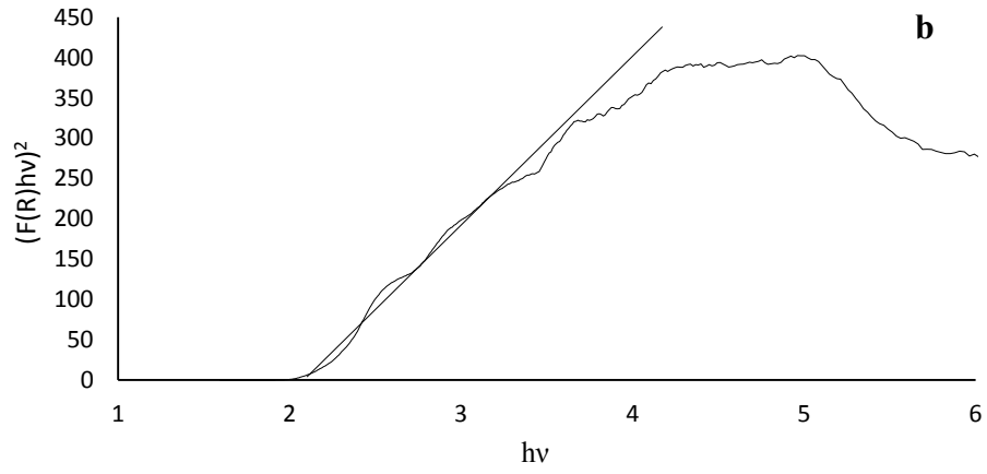
Şekil 17 ZnFe_2O_4 UV-Vis dağınık yansıtımlı spektroskopisi sonuçları
