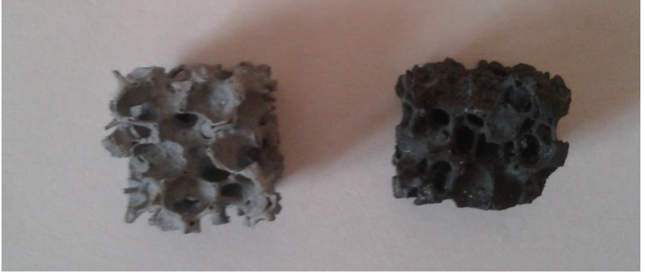
Şekil 3-64. 20 ppi SiC köpük destek yapısı; kaplanmamış (sol) ve kaplanmış (sağ) hali
