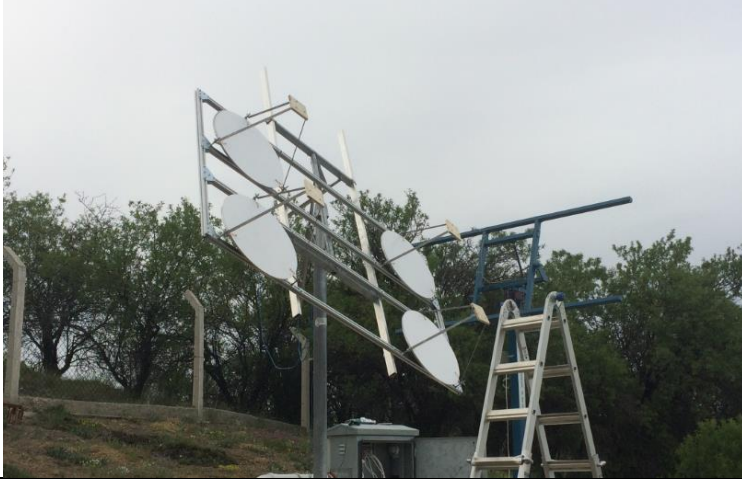
Çift eksenli takip sistemine monte edilmiş ayna platformu
