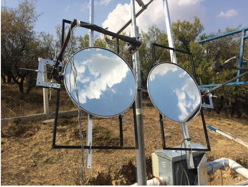
Şekil 3-7. Odaklayıcı doğrulama deneyleri için kullanılan düzenek
