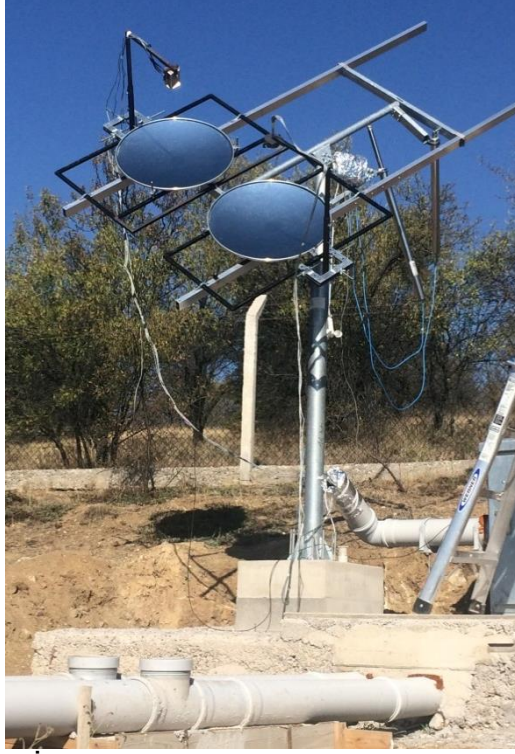
Şekil 3-6. İki ayna monte edilmiş çift eksen takip sistemi
