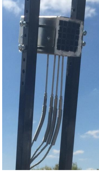
Şekil 3-9. Odaklamada kullanılan paslanmaz çelik monolit yapının yakın görüntüsü
