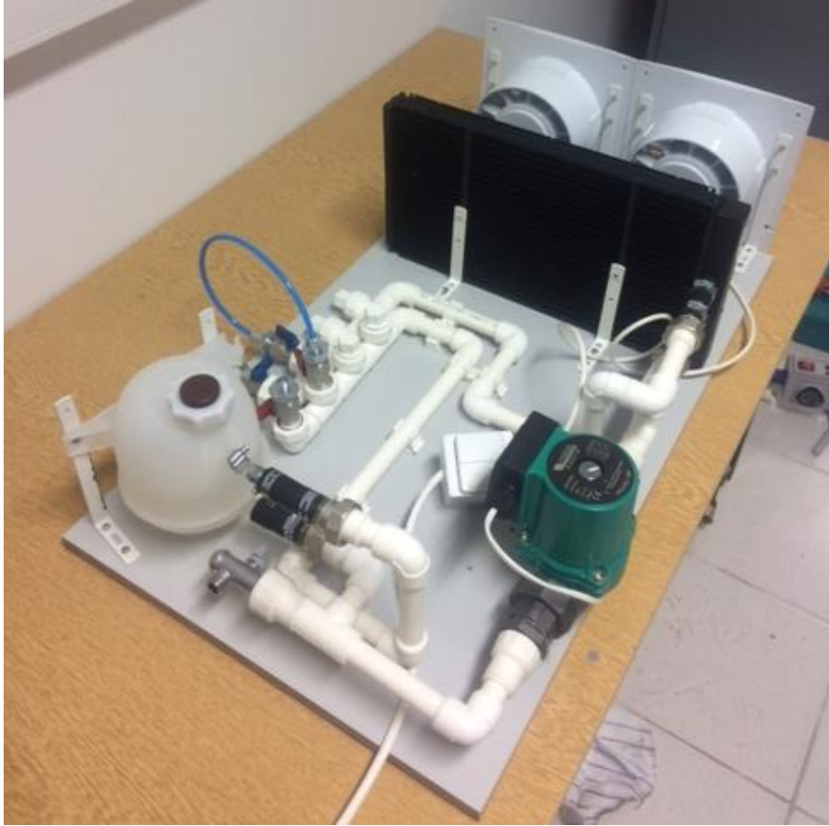
Şekil 3-16. Fırında ısıtılan haznelerin contaları soğutacak kapalı devre soğutma suyu sistemi
