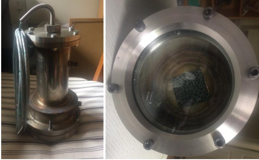
Şekil 3-48. Birleştirilmiş prototip reaktör ve monolit görüntüsü
