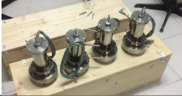
İmalatı tamamlanmış ve SiC köpük monolit yüklenmiş prototip reaktörler
