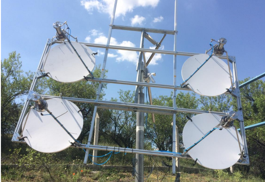
Ayna odaklarına yerleştirilmiş prototip reaktörler
