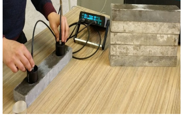
Şekil 3.29. Dolaylı iletim yöntemi ile UPV sonuçlarının ölçülmesi
