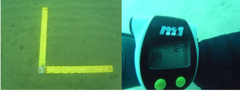
Şekil 34. Su altında kullanılan ölçük ve Mares M1 dalış bilgisayarı
