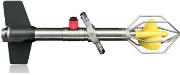
Şekil 28. Valeport Model 106 akıntı ölçer
