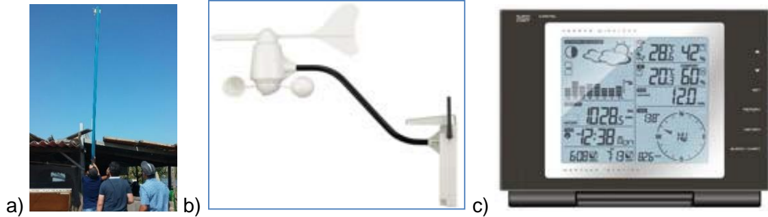
Şekil 31. a) Kurulu düzende meteoroloji istasyonu, b) Anemometre (rüzgâr sensörü), c) Ana konsol birimi
