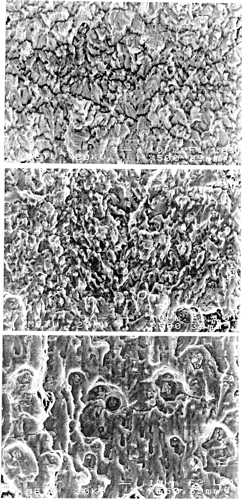
Şekil 4.32. Artan gerilim şiddeti alanı ile intermetaliklerin görünümüne geldiğini kanıtlayan SEM fotoğrafları (165°C'da 20 saat yaşlandırılan T-L konumlu örnek). (a) \Delta K=7.4 , (b) 11.3 ve (c) 15 \text{MPa}\sqrt{\text{m}} .
