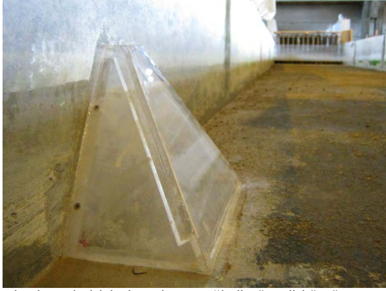
Şekil 3.3 Düz zemin deneyleri için hazırlanan eğimli yüzeyli köprü yan ayağı modeli ( L_a = 12.8\text{cm} ).
