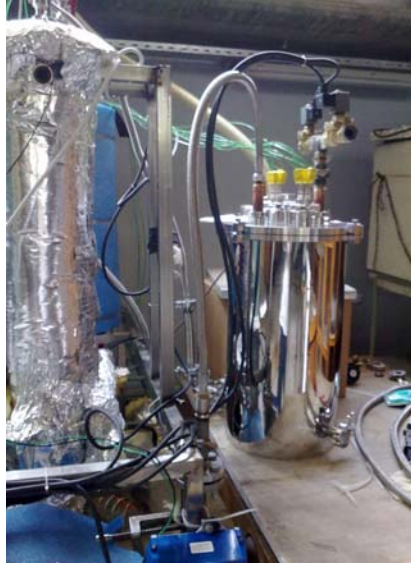
Şekil 4.13 Adsorban yatağının deney düzeneği üzerindeki görünümü.
