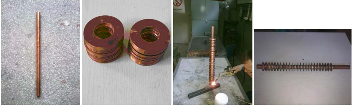
Şekil 4.7 Kanatçıklı bakır boru imalat safhaları.
