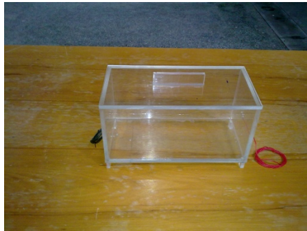
Şekil 4.1 Geçici rejimde çalışan ısı iletkenlik deney düzeneği.
