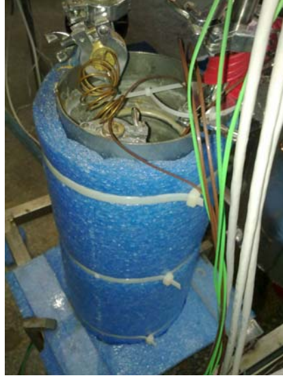
Şekil 4.12 Buharlaştırıcı ünitesi ve yerleştirildiği su tankı.
