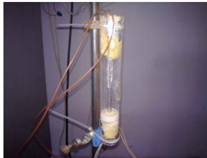
Őekil 4.2 Kararlı durumda alıŐan ısı iletkenlik deney dzeneđi.
