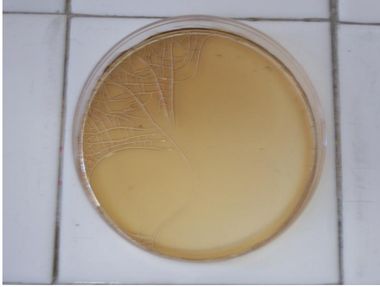
Şekil 4.2. Plastikleştirici olarak gliserol kullanılmasının huş ağacı ksilanı bazlı filmlere etkisi
