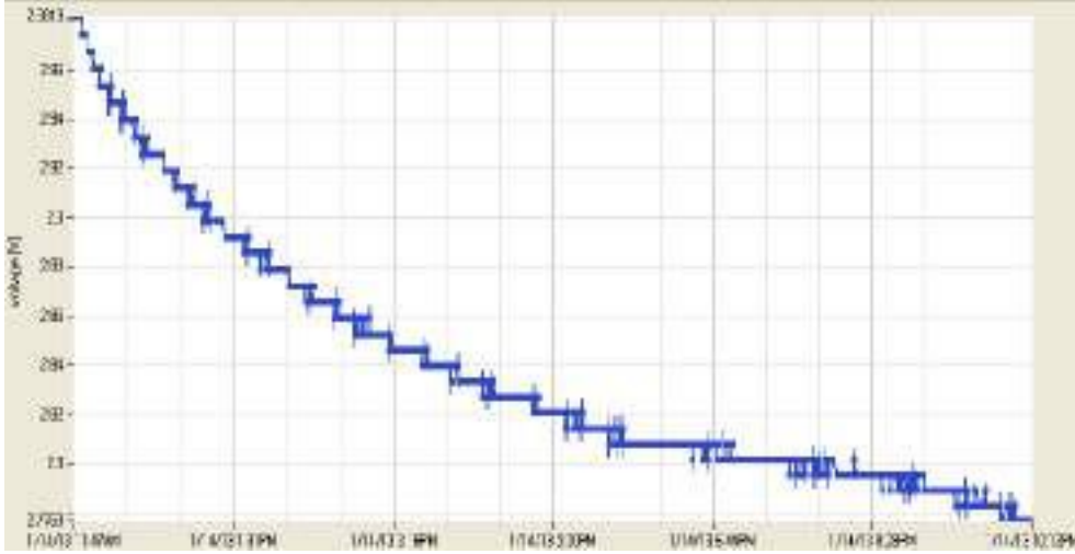
Şekil 40. MicaZ düğümünün Yüksek Güç çalışma durumunda 10.5 saat boyunca çalışması esnasında batarya gerilim düzeyinde gözlenen değişimin zamana karşı grafiği
