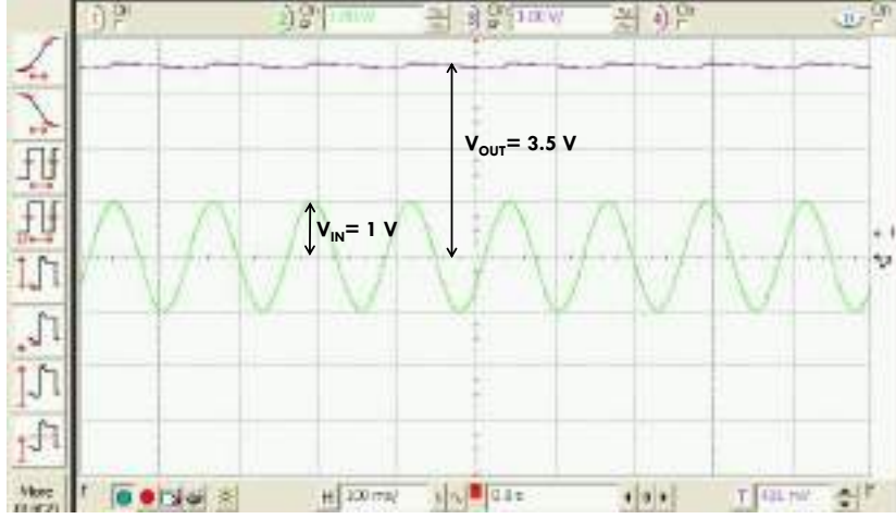
Şekil 18. Devrenin 1V ve 10 Hz giriş voltajı ile yapılmış olan test sonucu.
