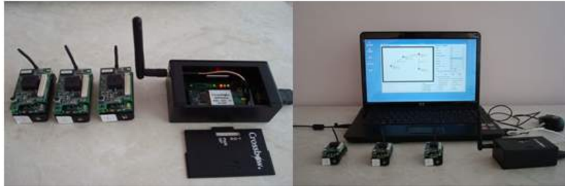
Şekil 32. MicaZ tabanlı test düzeneği ve bileşenleri.
