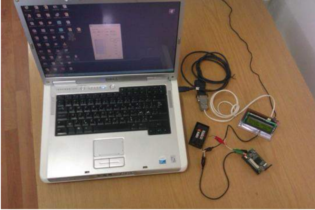
Şekil 35. MicaZ ünitesinin farklı durumlardaki akım tüketimini ölçme düzeneği
