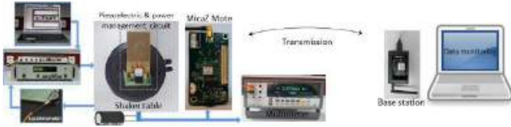
Şekil 83. Enerji-nötr enerji üreteçli sensör düğümü test düzeneği.
