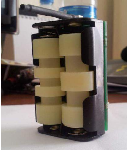
Şekil 14. Üretilen enerji üretici gövdelerinin AA tipi pil yuvasına yerleştirilmiş hali.
