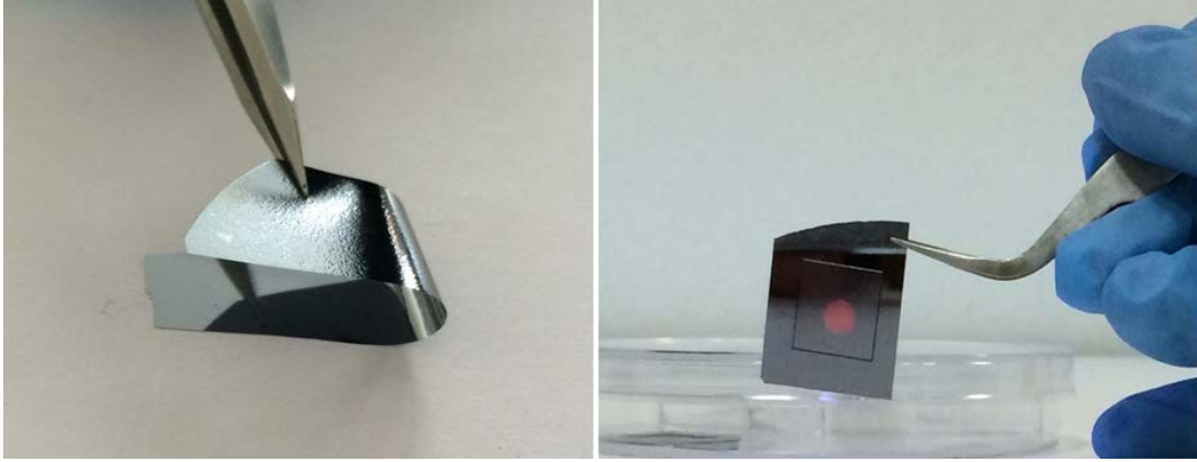
Şekil 14. 20 µm kalınlığındaki ultra-ince silisyum pulun fotoğrafları. Esnek silisyum pulun cımbızla bükülmüş hali (solda) ve arkasından lazer ışığı tutulmuş hali (sağda).
