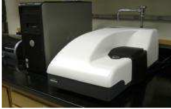
Şekil 8. Tanecik boyut analizi deney düzeneği.
