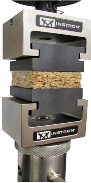
Şekil 4. Yongalevha yüzeye dik çekme direnci düzeneği
