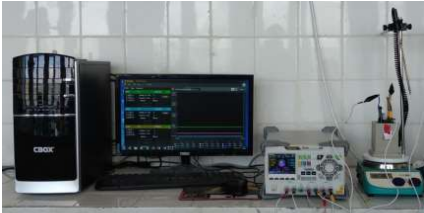
Şekil 3.9. Programlanabilir güç kaynağı.
