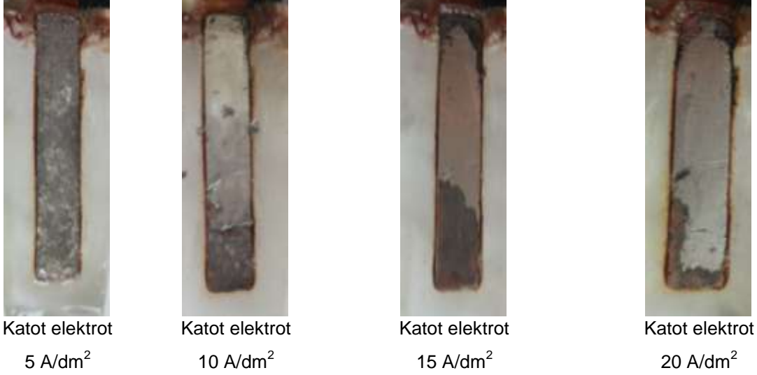
Şekil 6.10. Deneylerin sonunda oluşan kaplamaların makro fotoğrafları.
