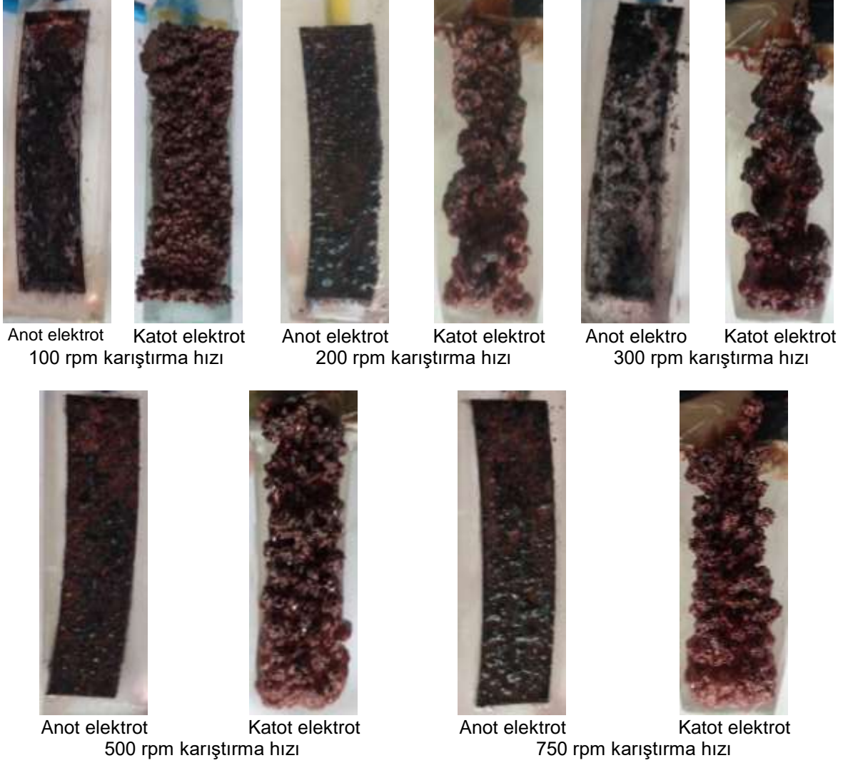
Şekil 6.16. Kobalt esaslı soketlerde elektrolit karıştırma hızının elektro çözündürme ve toz metal üretim prosesine etkisi.
