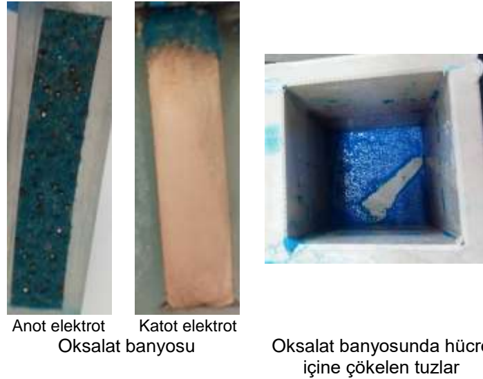
Şekil 8.1. Bronz kaplama banyosunda yapılan elektro çözündürme deney fotoğrafları.
