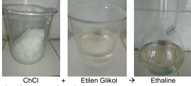
Şekil 3.5. Ethaline iyonik sıvısının hazırlanışı.
