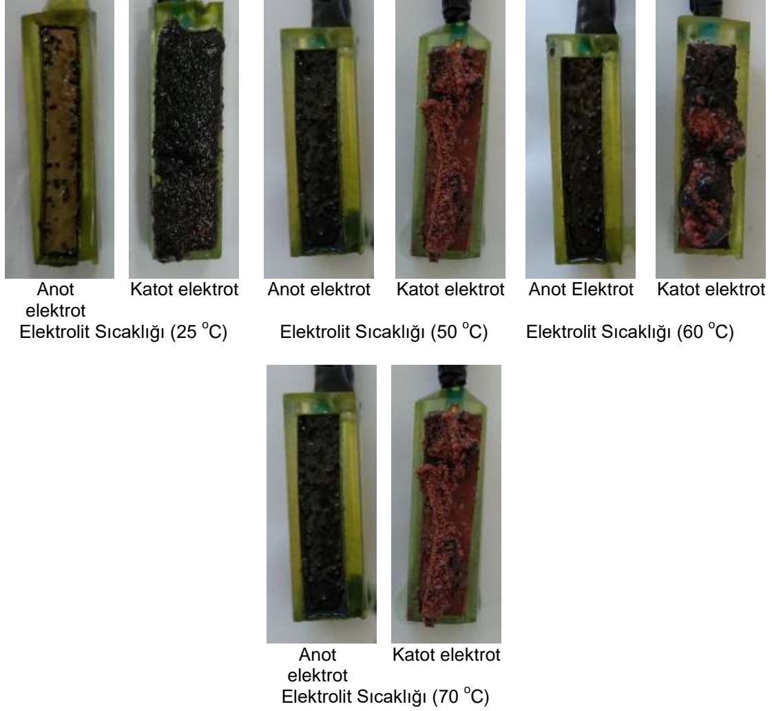
Şekil 9.11. Elektrolit sıcaklığının etkisini incelemek için yapılan deneylerde kullanılan anot ve katodun makro fotoğrafları.
