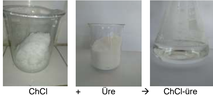
Şekil 3.6. Kolin klorür – üre iyonik sıvısının hazırlanışı.
