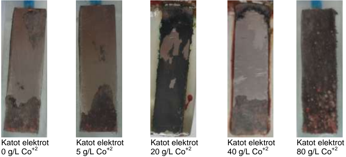
Şekil 6.5. 0 - 80 g/L Co derişiminde yapılan çalışmalarda deney sonrası katotta oluşan kaplama
