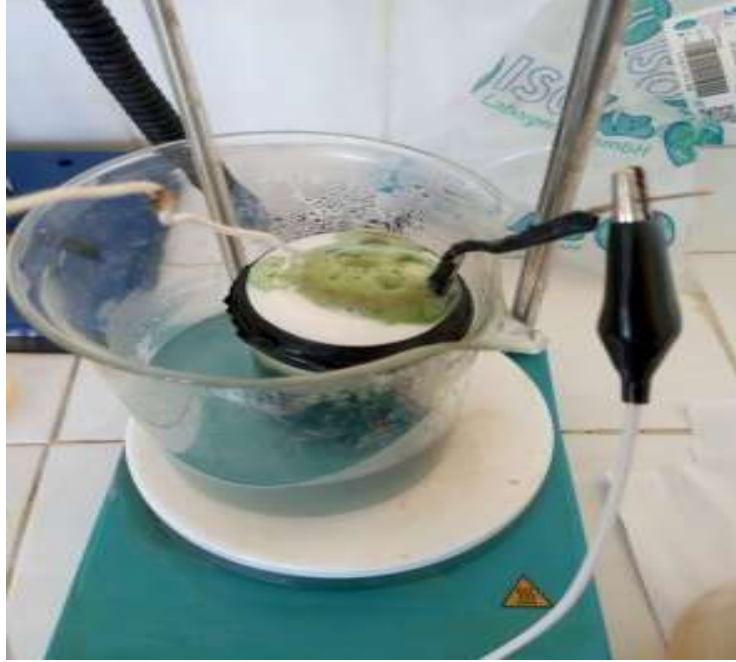
Şekil 5.2. Bakır soketin 70 °C'de ethaline iyonik sıvısı ile yapılan deneyde köpürmenin gösterimi.
