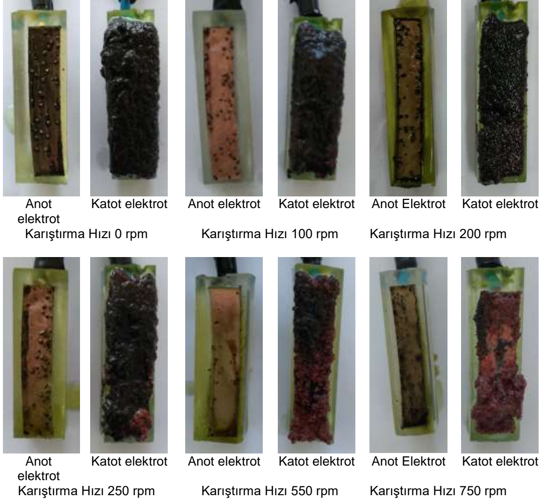
řekil 9.14. Karıřtırma hızının etkisini incelemek için yapılan deneylerde kullanılan anot ve katodun makro fotoęrafları.
