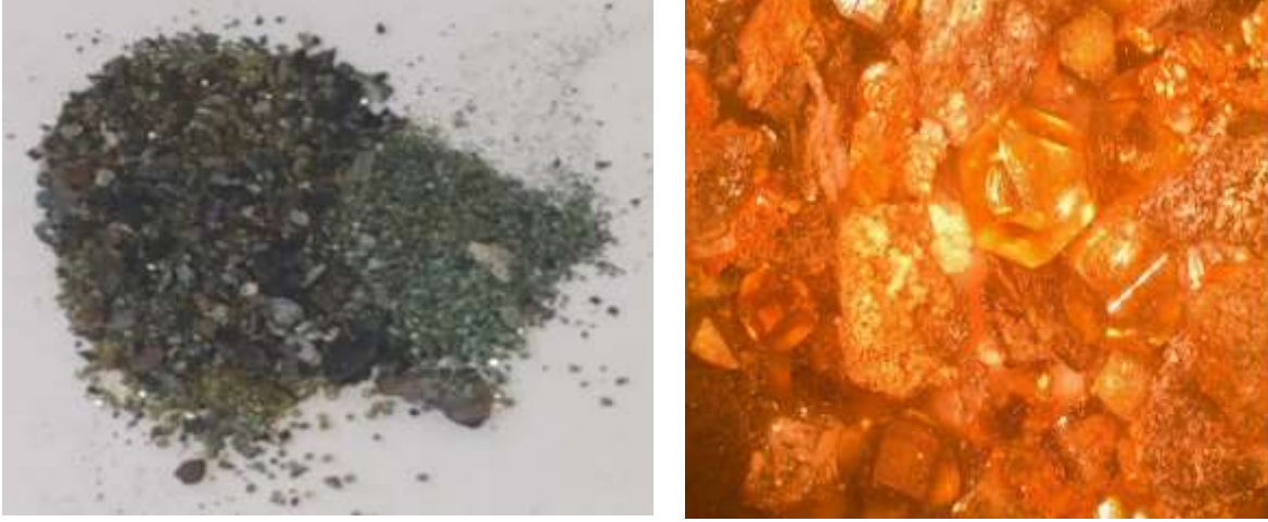
Şekil 3.24. Prototip sisteminde geri kazanılan elmasların makro ve optik mikroskop fotoğrafları.
