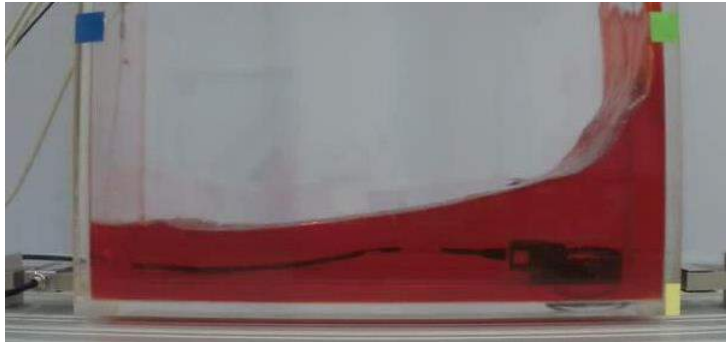
Şekil 51. 7 mm genlikte ve 1 Hz frekansında sinüs çalkalanmasında 6. saniyedeki sıvının kap içindeki görünümü (üstte: sayısal benzetim, altta: deney)
