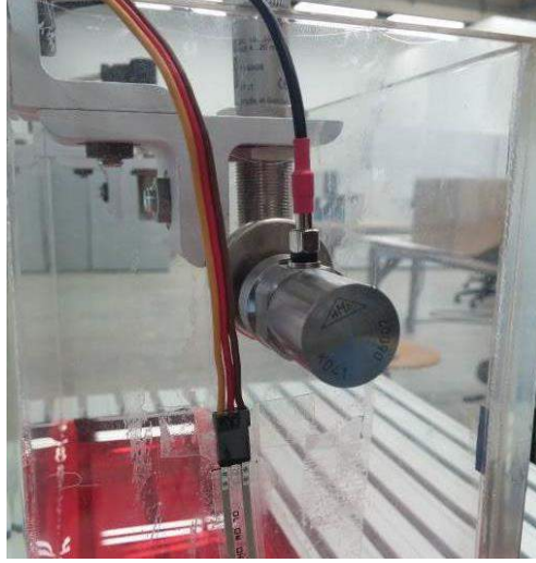
Şekil 15. İvmeölçer mıknatıs ile kaba tutturulmuştur
