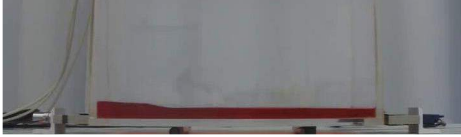
Şekil 48. 2 cm genlikte ve 0.5 Hz frekansında sinüs çalkalanmasında 2. saniyedeki sıvının kap içindeki görünümü (üstte: sayısal benzetim, altta: deney)
