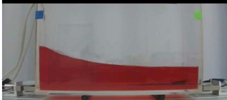
Şekil 49. 2.5 mm genlikte ve 1 Hz frekansında sinüs çalkalanmasında 8. saniyedeki sıvının kap içindeki görünümü (üstte: sayısal benzetim, altta: deney)
