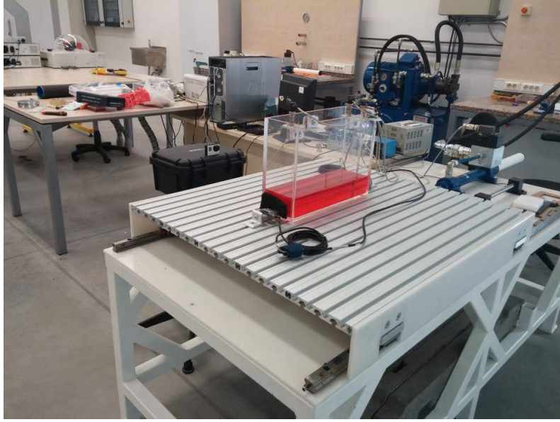
Şekil 27. Çalkalanan sıvı deneysel çalışmaları için hazırlanan test düzeneği
