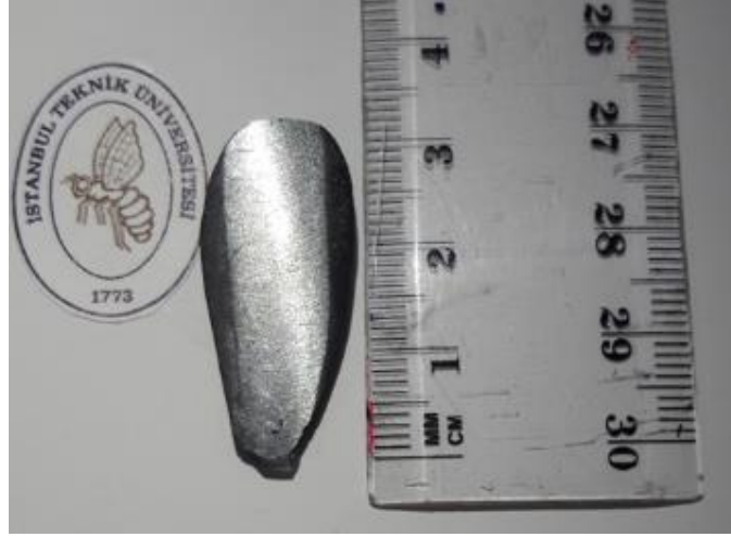
Şekil 4.2.2: Bridgman sistemiyle elde edilen stokometrik CZTS külçesi (ingot).
