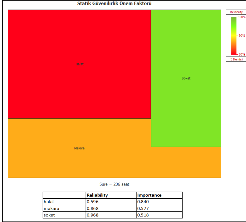
Şekil 129. Marion terazi ünitesinin 50% güvenilirlik seviyesindeki (236. saat) önem faktörleri
