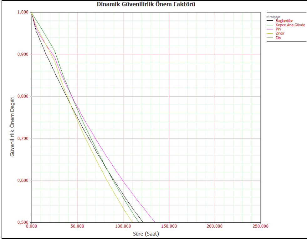
Şekil 131. Marion kepçe ünitesi bileşenlerinin zamana bağlı RI değerleri
