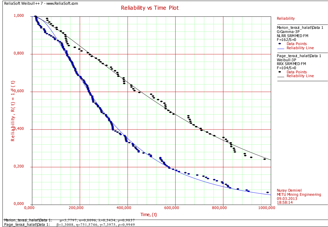
Şekil C7. Çekme kepçeli yer kazarların terazi ünitesi halat bileşeninin güvenilirliği
