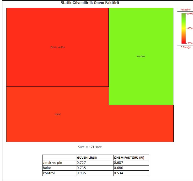
Şekil 122. Page çekiş ünitesinin 50% güvenilirlik seviyesindeki (171. saat) önem faktörleri
