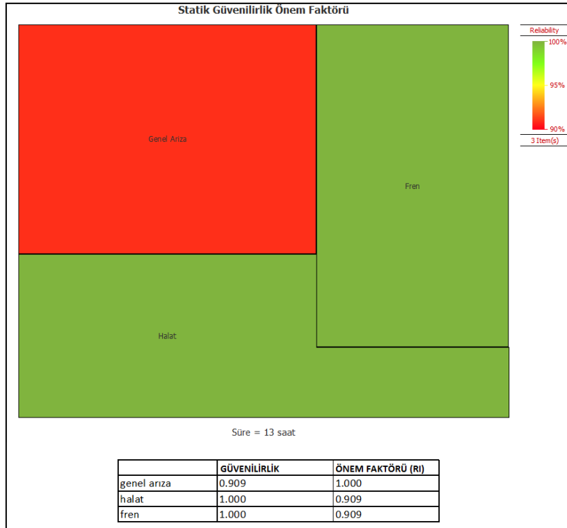
Şekil D6. Marion kaldırış ünitesinin 90% güvenilirlik seviyesindeki (13. saat) önem faktörleri
