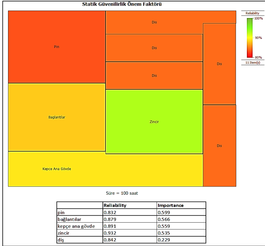
Şekil 133. Marion kepçe ünitesinin 50% güvenilirlik seviyesindeki (100. saat) önem faktörleri
