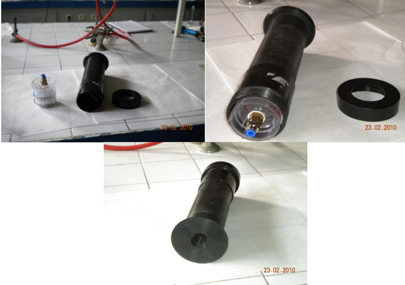
Şekil 2.11 Stack Filter Unit örnekleme sisteminde PM10 ön impactor ve filtre tutucusu
