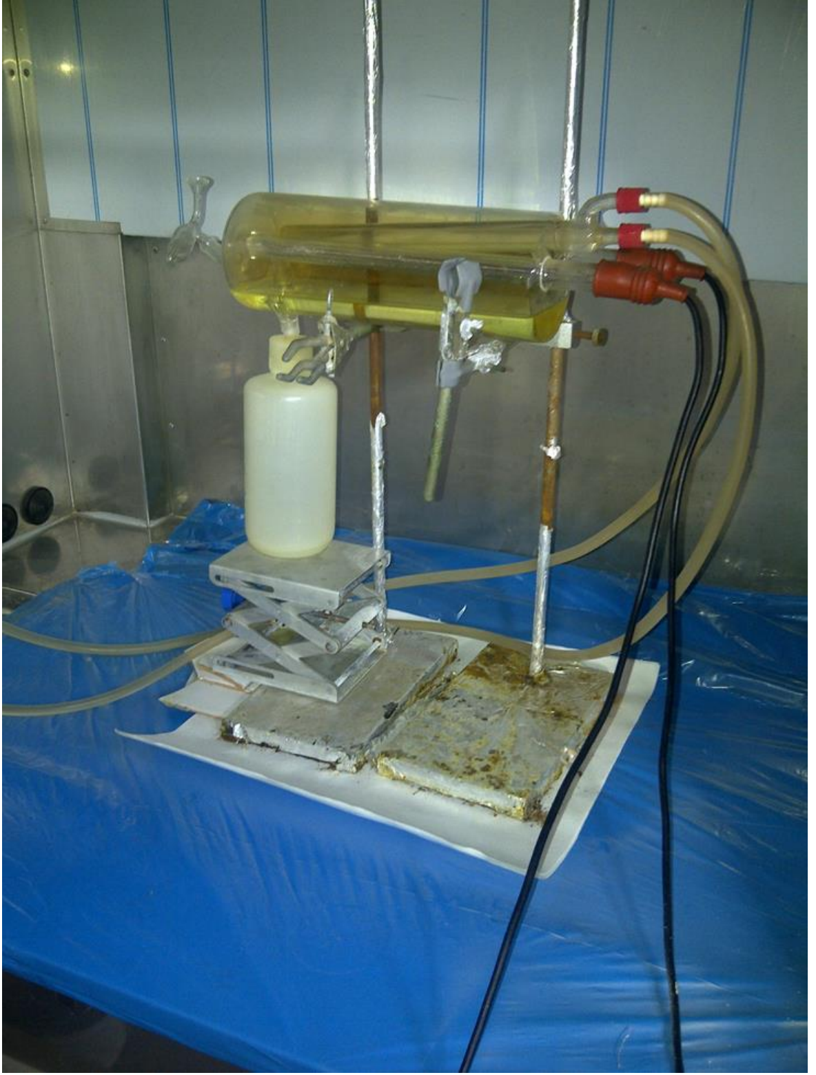
Şekil 2.19 Çalışmada kullanılan "sub-boiling destilasyon ünitesinin fotoğrafı
