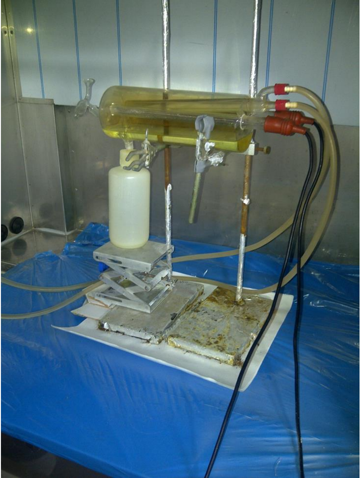
Şekil 2.19 Çalışmada kullanılan "sub-boiling destilasyon ünitesinin fotoğrafı
