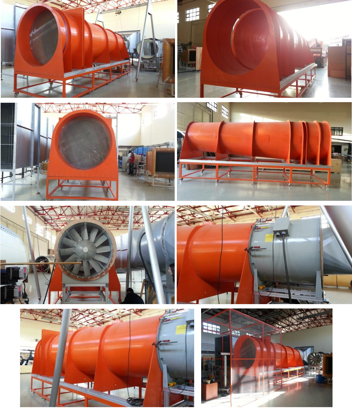
Şekil 10. Üretilen açık jet rüzgar tüneli resimleri
