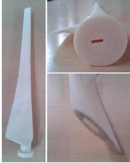
Şekil 19. Hızlı prototipleme ile ABS plastikten üretilen rotor pali
