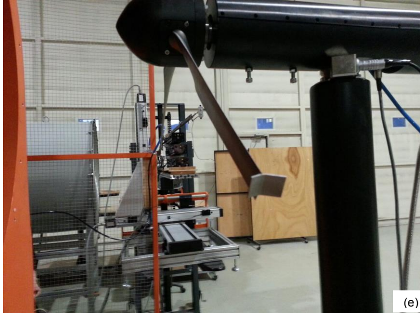
Şekil 33. V-tipi kanatçıklar (a) üretim için hazırlanan alüminyum kalıp, (b) tel erozyon ile üretilen V-tipi kanatçıklar, (c,d) V-tipi kanatçığın kanat ucundaki yerleşimi, (e) türbin rotoruna entegre edilmiş durum
