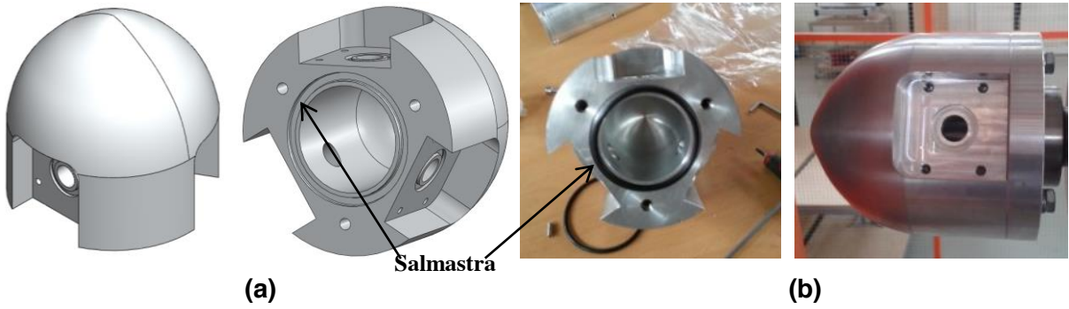
Şekil 25. (a) Basınçlı hub katı modeli, (b) üretilen basınçlı hub
