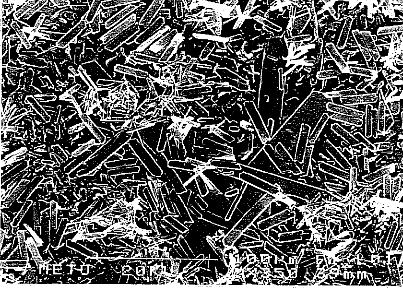
Şekil 4.9.a. Al_2O_3 altlık üzerinde üre kullanılmadan elde edilen ve ısıtma işlem öncesi 150^\circ C 'de 2 saat süreyle kurutulan PZT filmin SEM görüntüsü.
