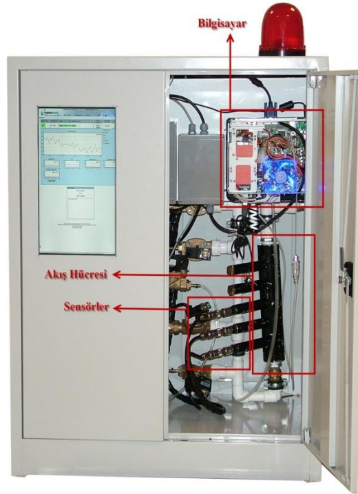
Şekil 2.1. Nanoseus cihazının iç görüntüsü ve akış hücresi.
