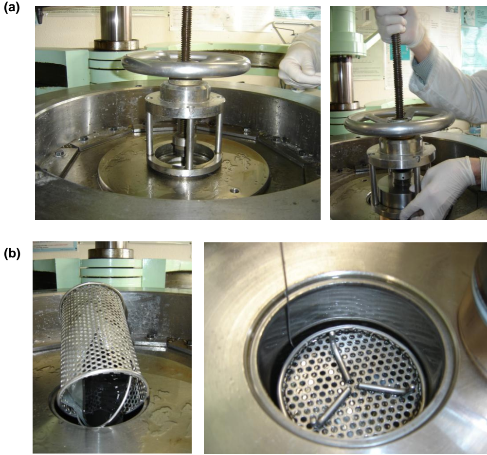
Şekil 7. v-YHB basınç haznesi: (a) Hazneden sepetin çıkarılması, (b) Sepete örneklerin yerleştirilip cihaza konulması.
