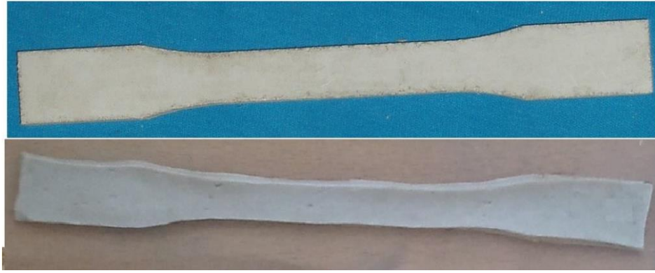
Şekil 3. 9. Standart ve büzüşmüş pik test numuneleri (Guner, 2014)
