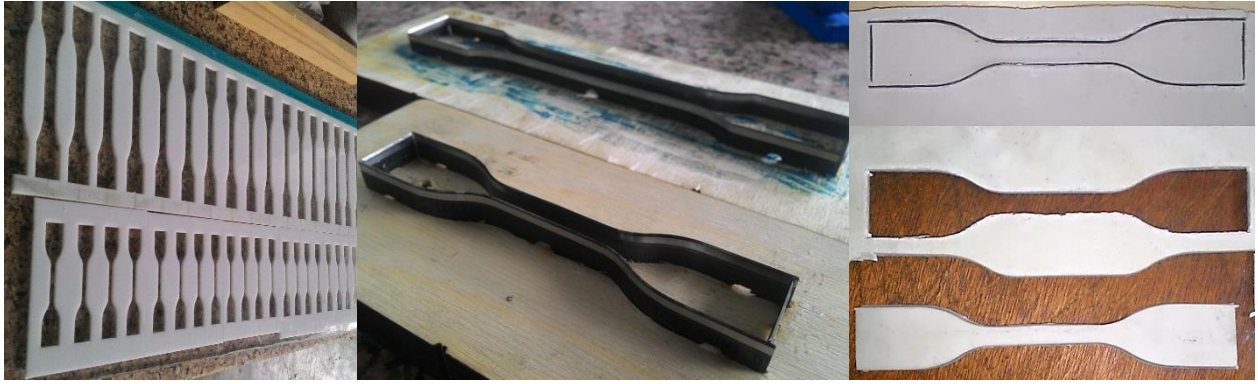
Şekil 3. 5. Kalıp, kesme aparatları ve numune hazırlanışı
