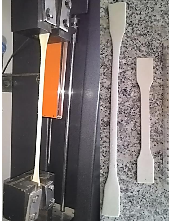
Şekil 3. 11. PİK-2 için yapılan 1-gün kontrol deneyi
