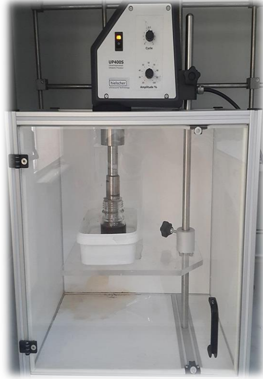
Şekil 13. Hielscher marka ultrasonikasyon cihazıyla nanoakışkanların hazırlanması
