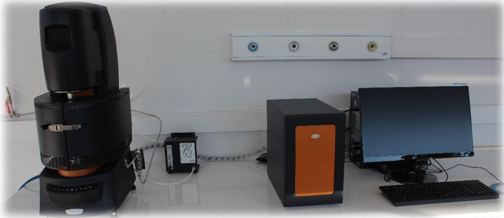
Şekil 17. TA Instruments, HR-2 reometre
