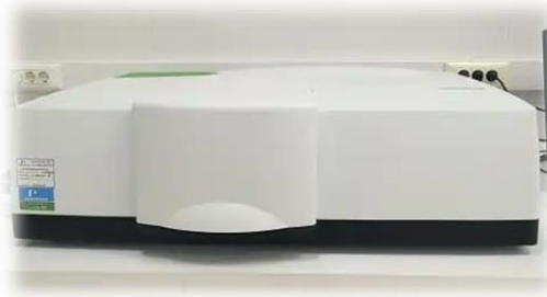
Şekil 16. Perkin Elmer, LAMBDA 950 UV-Vis Spektrofotometresi
