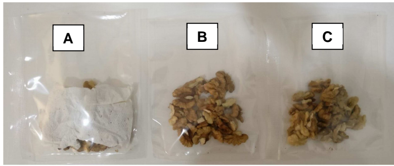
Şekil 10. Ambalajlanan ceviz örnekleri A: HPMC/PEO bazlı nanolif içeren ambalaj, B&C: kontrol ambalaj
