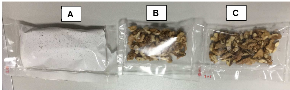
Şekil 11. PLA içine ambalajlanan ceviz örnekleri A: HPMC/PEO bazlı nanolif içeren ambalaj, B&C: kontrol ambalaj
