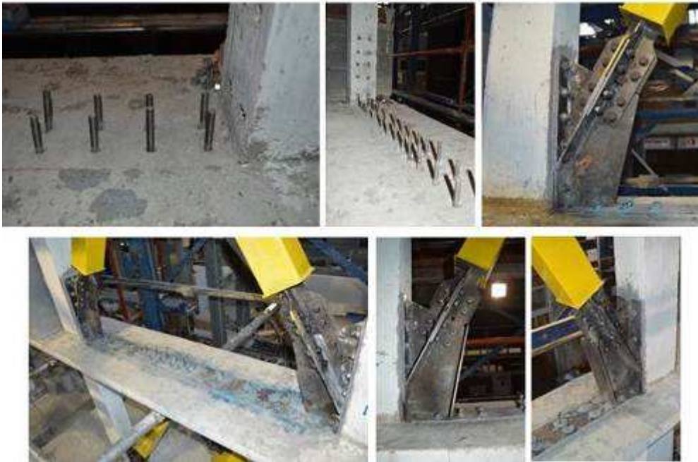
Şekil 3.11. Kolon-kiriş düğüm noktasında bağlantı detayı
