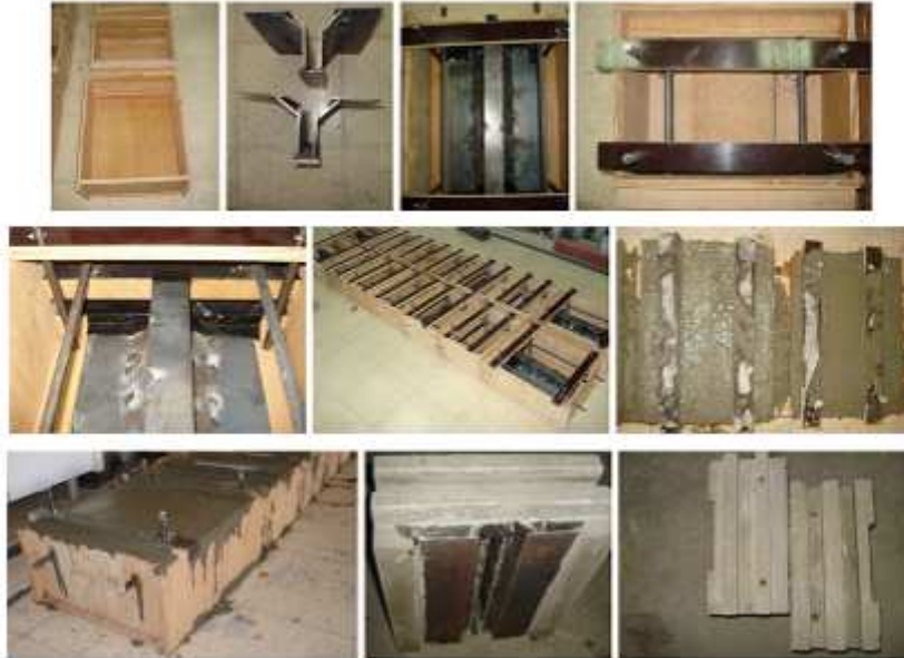
Şekil 2.29. 1. BEÇÇ_3 eleman yapım detayı
