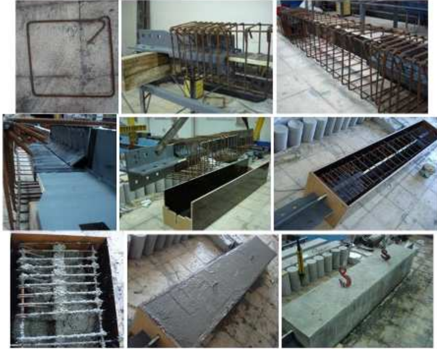
Şekil 2.21. 9. BEÇÇ_1 eleman yapım detayı
