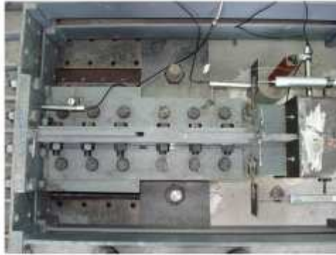
Şekil 2.9. BEÇÇ ve deney düzeneği bağlantısı
