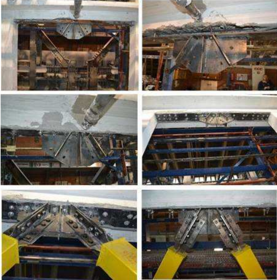
Şekil 3.10. Kiriş orta açıklığında bağlantı detayı
