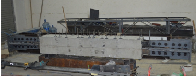
Şekil 2.30. BEÇÇ için çerçeve yapımı ve PP'lerin birleştirilmesi
