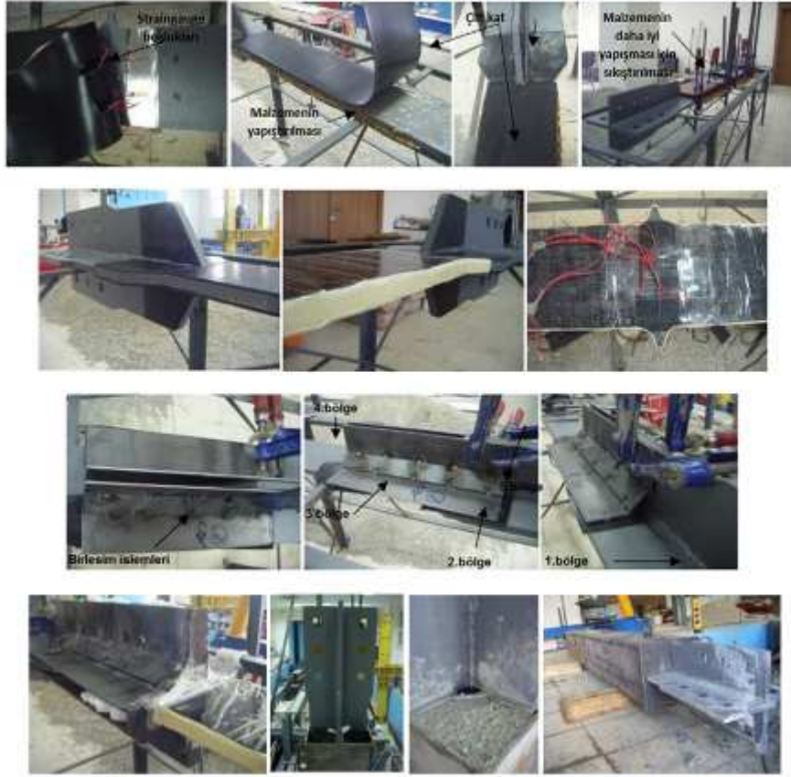
Şekil 2.15. 5. BEÇÇ_1 elemanı yapım detayı
