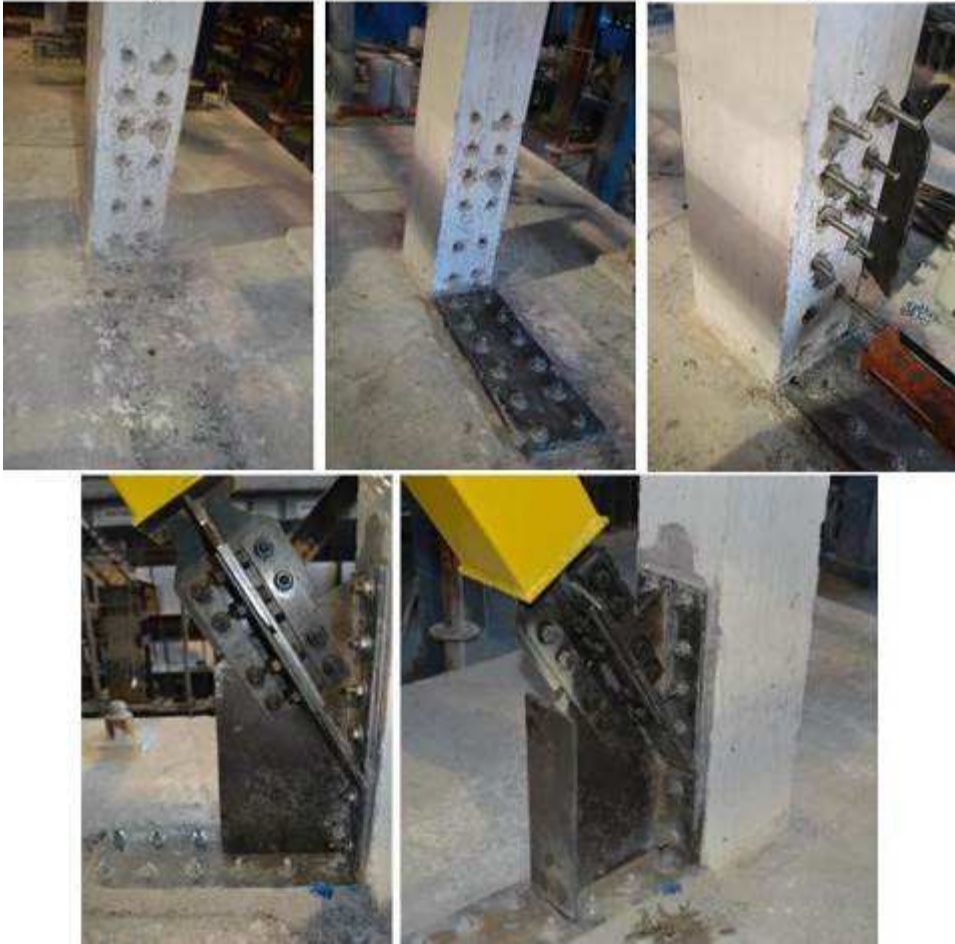
Şekil 3.9. Kolon dibinde bağlantı detayı
