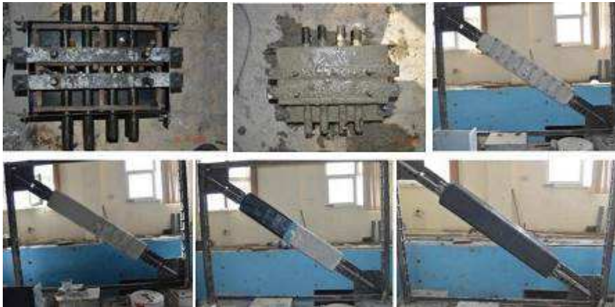
Şekil 2.42. 7. BEÇÇ_3 eleman yapım detayı
