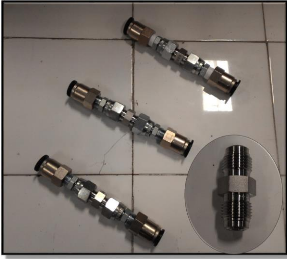
Şekil 28. Kullanılan kritik orifislerin fotoğrafı ve teknik özellikleri
