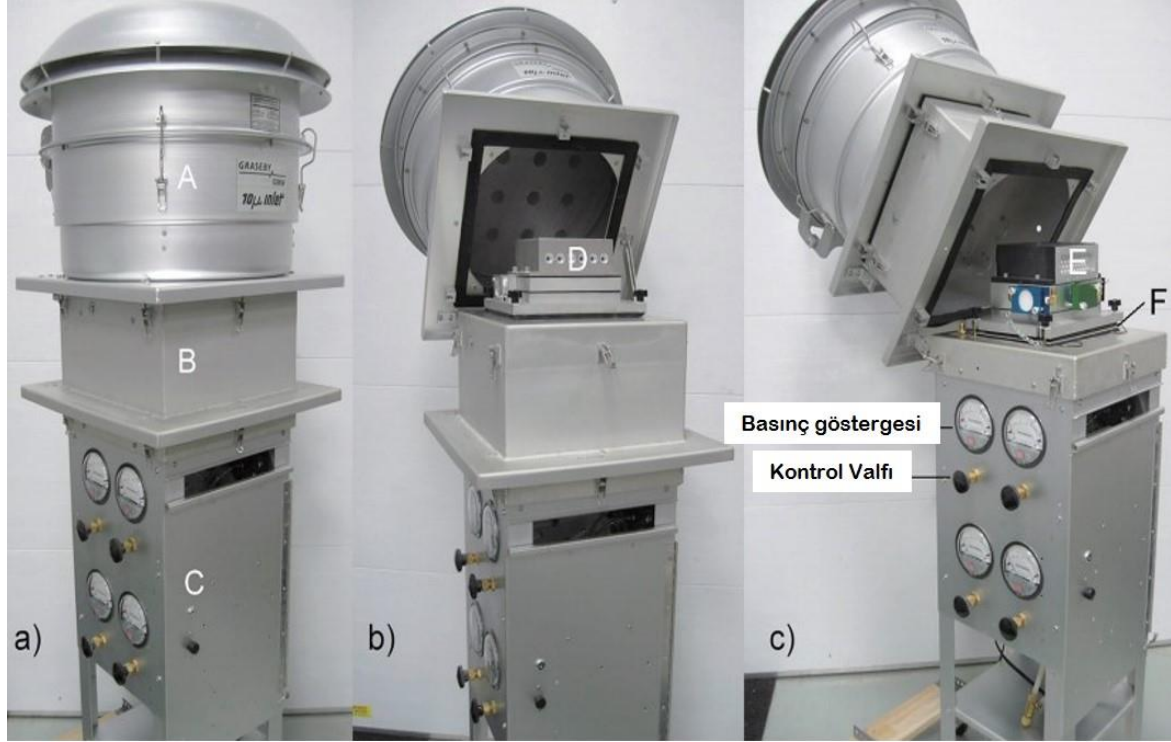
Şekil 17: PM1.0/2.5/10 Trichotomous örnekleyici. a) Monte edilmiş örnekleyici; b) 2.5 µm HVVI; c) 1.0 µm HVVI. A- PM10 giriş; B- Ara hazne; C- taban; D- 2.5 µm HVVI; E- 1.0 µm HVVI; F-Nihai filtre (Marple vd., 2014).
