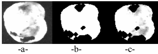
Şekil 3. a-) Fındığın 550 nm dalgaboyundaki görüntüsü, b-) maske, c-) maskelenmiş görüntü
