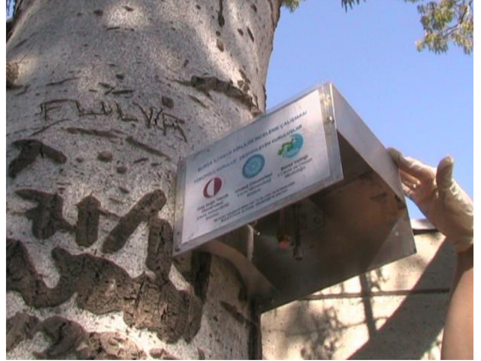
Şekil 6. Pasif örnekleme tüplerini meteorolojik faktörlerden koruyan sistem
