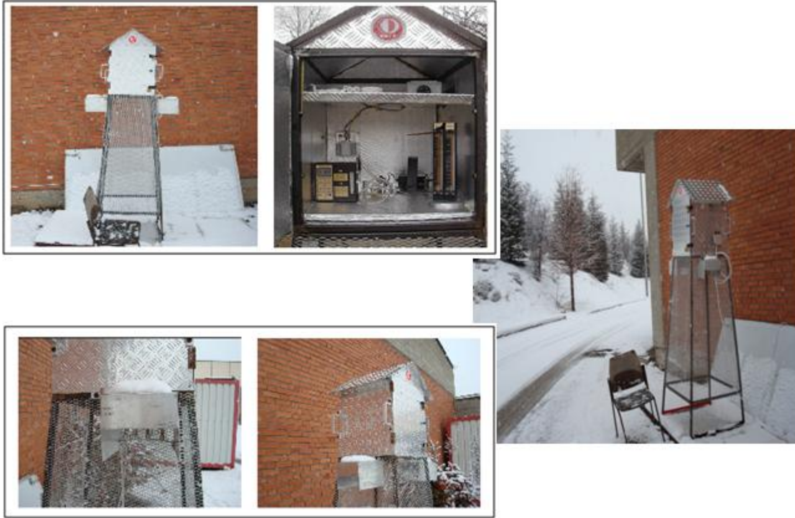
Şekil 2. Örnekleme sırasında pasif ve aktif örnekleme tüplerinin yerleştirildiği kabin
