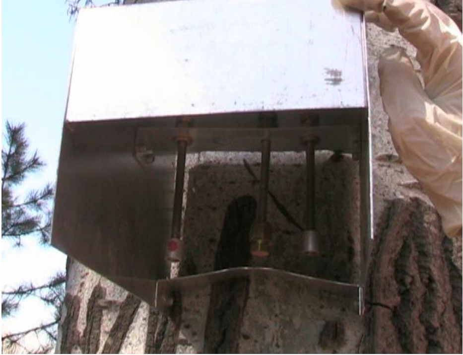
Şekil 6. Pasif örnekleme tüplerini meteorolojik faktörlerden koruyan sistem
