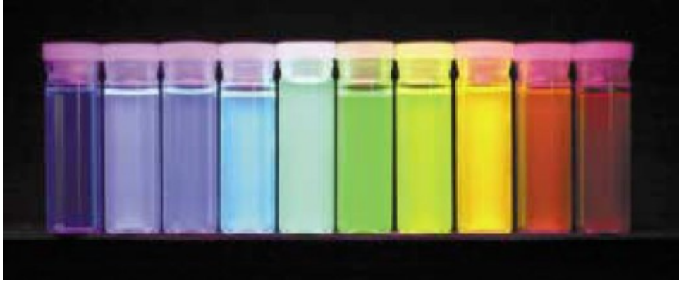
Şekil 2. Çapları 2-7 nm arasında olan CdSe kuantum noktacıklarının emisyon dalga boyu değişimi (HAN, 2001).
