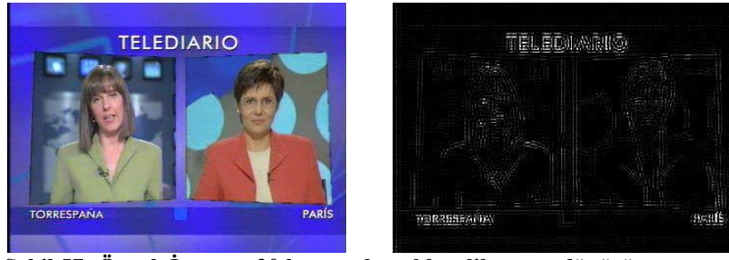
Şekil 57: Örnek İmge ve 20 katsayıdan elde edilen ters dönüşüm.
