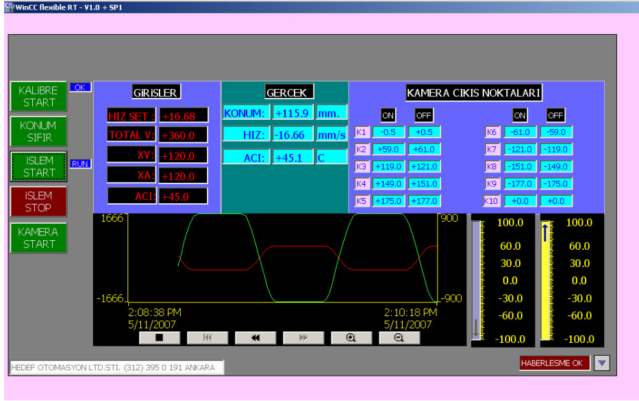
Şekil 14 Çırpın kanat hareketini sağlayan programa verilerin girildiği arayüz
