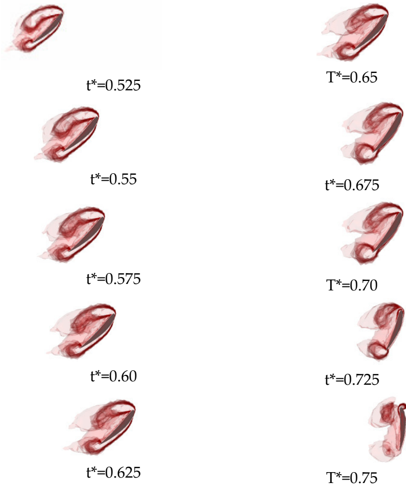
Şekil 73 (Devam) Üç boyutlu sayısal çalışmalar için aşağı doğru çırpma hareketinin üçüncü çeyrek periyodunda \alpha=45^\circ , Re =1000 için Q=8 eş değer çizgilerinin karşılaştırılması.
