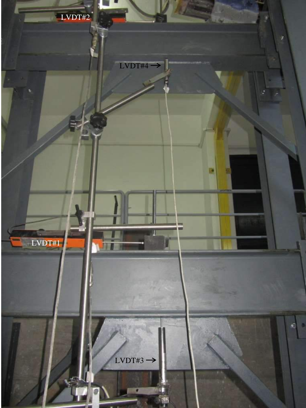
Şekil 7-8. Ters-V çaprazlı çerçevenin ölçme düzeneği şeması.
