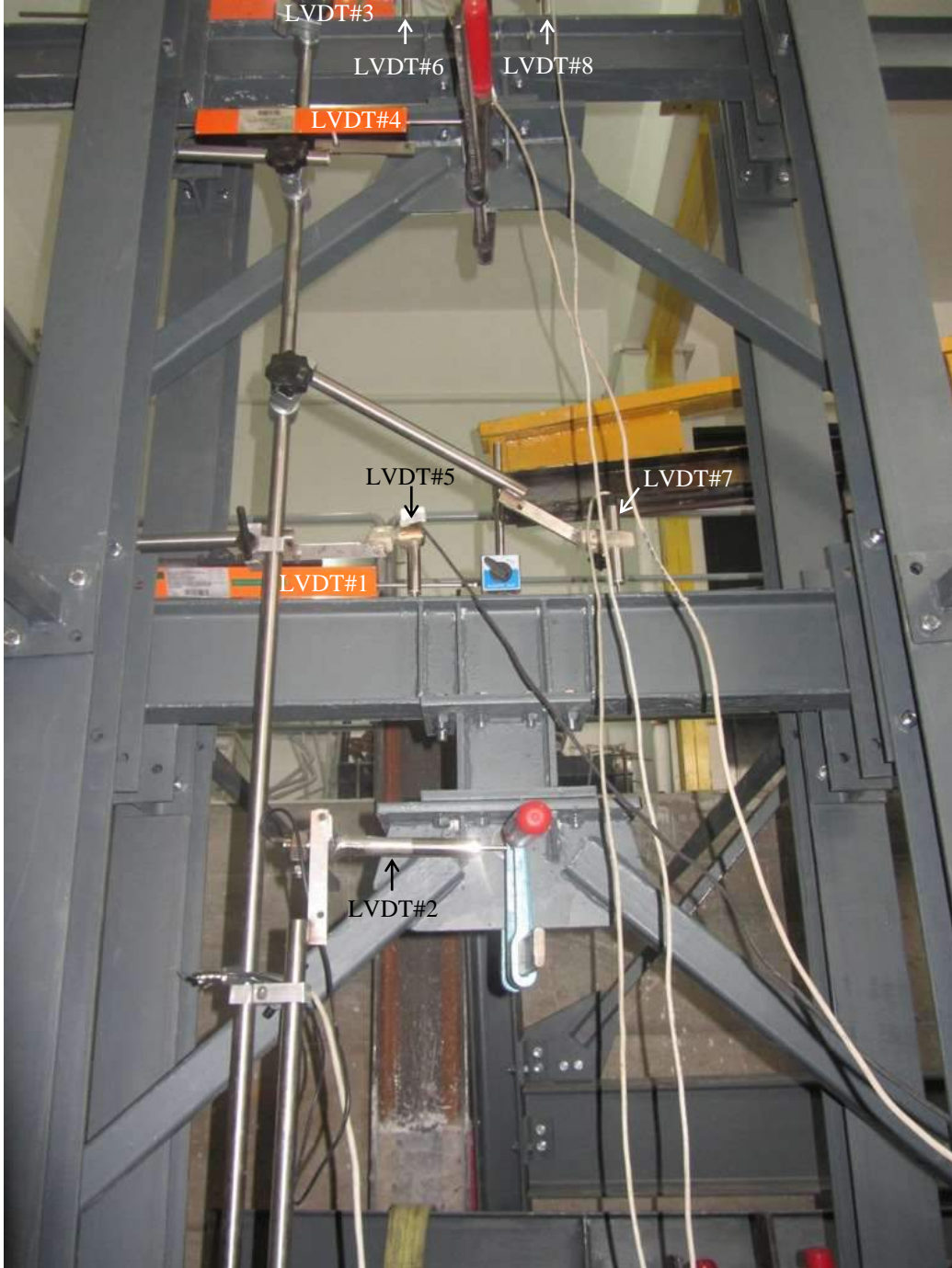
Şekil 7-7. H-link dış-merkez çaprazlı çerçevenin ölçme düzeneği şeması.
