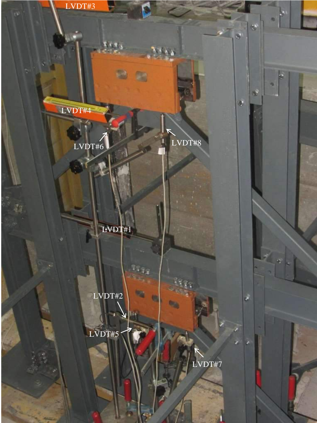
Şekil 7-6. BHD'li çerçevenin ölçme düzeneği şeması.
