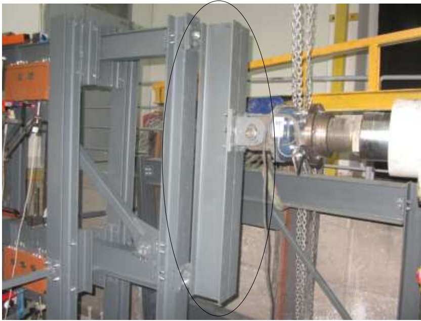
Şekil 7-10. Yük hücresi ve çerçeveye bağlanmış halde görülen yükleme aparatı,
